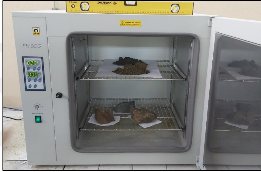
Şekil 3.13 Numunelerin 105 C° ye ayarlanan etüve yerleştirilmesi
