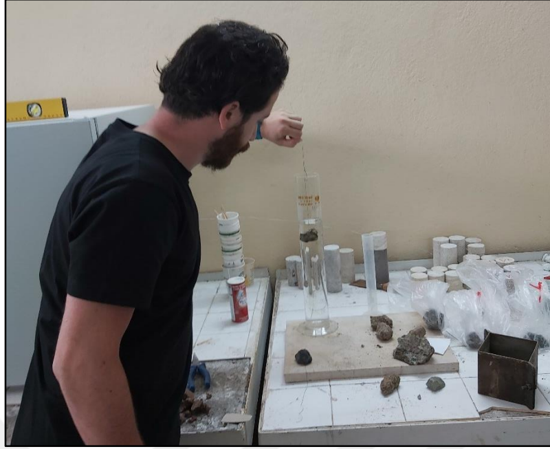
Şekil 3.12 Parafinli numune su dolu mezüre daldırılarak hacim tespiti
