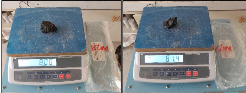
Şekil 3.11 Parafinsiz ve parafinli numunelerin tartımı
