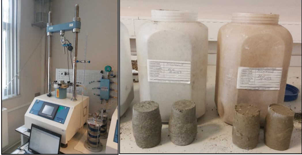
Şekil 3.15 Üç eksenli basınç deney düzeneği ve deney sonrası numune örnekleri
