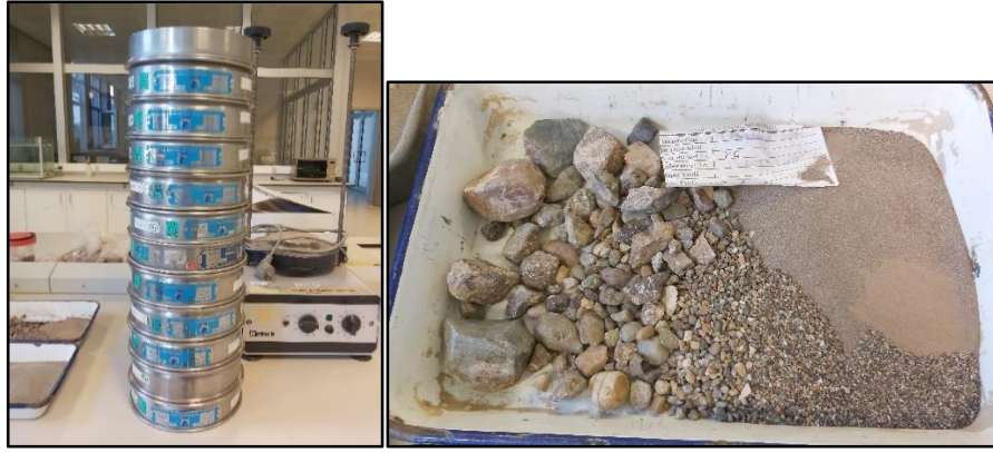
Şekil 3.17 Standarta uygun elek takımı ve eleme sonrası malzeme boyutları (KÇ)
