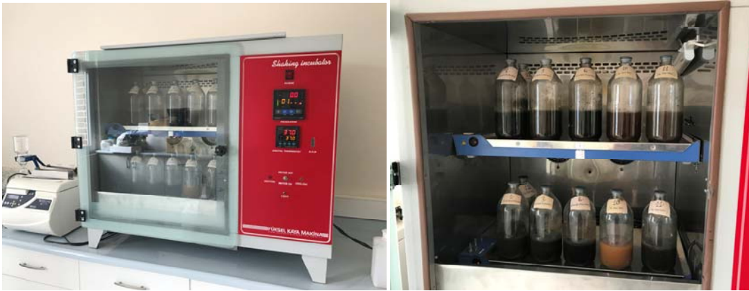
Şekil 3.6. Deneysel çalışmada kullanılan sıcaklık kontrollü çalkalamalı inkübatörün görünüşü
