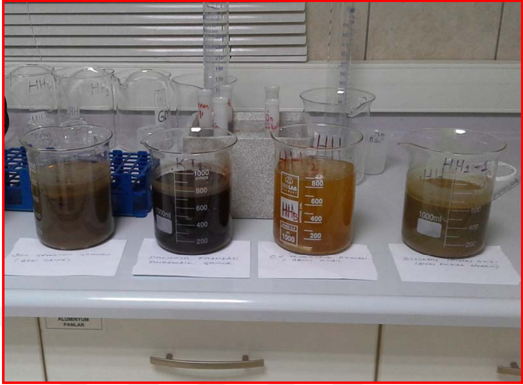
Şekil 3.3 Sebze atıkları, büyükbaş hayvan gübresi ve arıtma çamurlarının karakterizasyonu öncesi numune hazırlama
