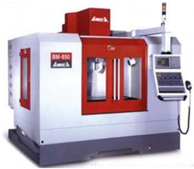
Şekil 6.14 SKK uygulamaların gerçekleştirildiği AWEA BM-850 tezgâhın genel görünümü ve teknik özellikleri
