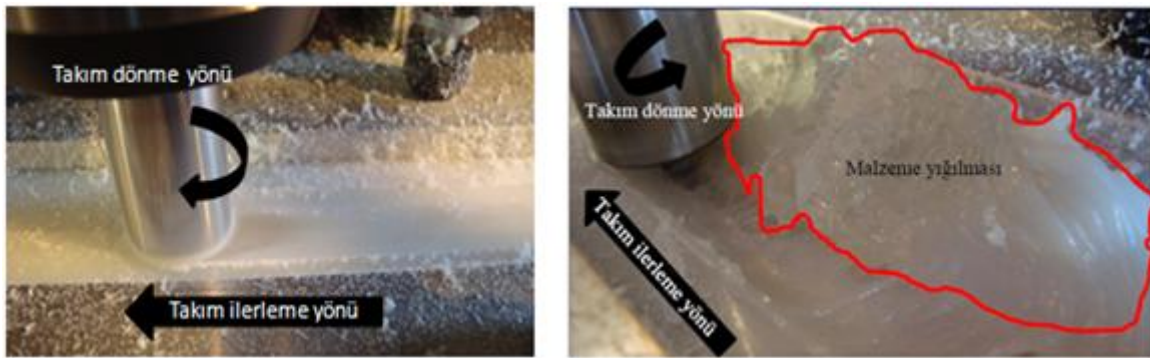
a) Saat ilerleme yönünde b) Saat ilerleme yönünün tersinde Takım dönme devri: 4000 devir/dk, takım ilerleme hızı: 20 mm/dk.
