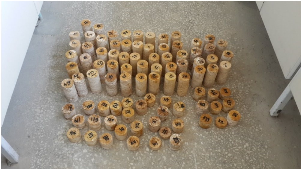
Şekil 2.8. Karot numunelerinin numaralandırılarak deney öncesi hazır hale getirilmesi
