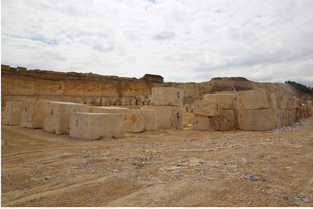
Şekil 2.3. Traverten ocağında istiflenmiş traverten blokları (Özmersan A.Ş.)
