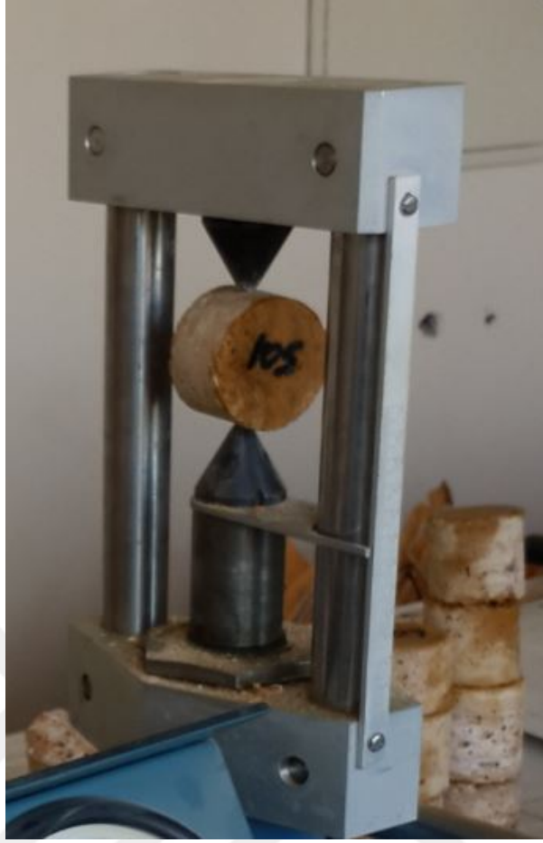
Şekil 2.11. Çapsal Nokta Yük Dayanım Deneyi
