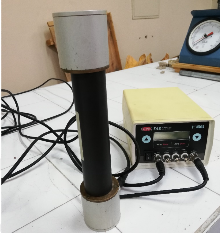
Şekil 2.9. Deneyde kullanılan Ultrasonik Dalga Hızı Test Cihazı
