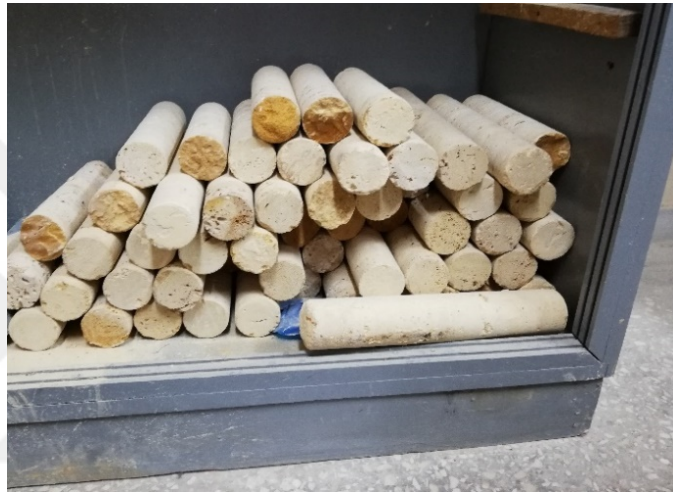
Şekil 2.5. Numunelerin karot makinasıyla kesilmesi ve istiflenmesi
