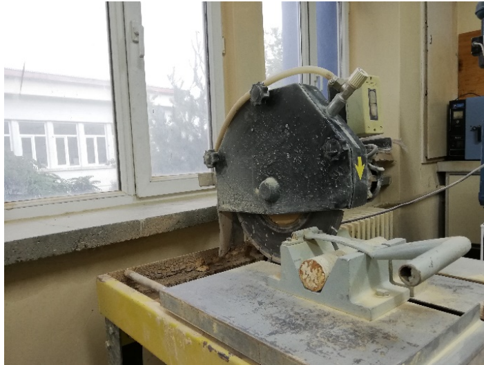
Şekil 2.6. Karot numunesinin kesilmesi
