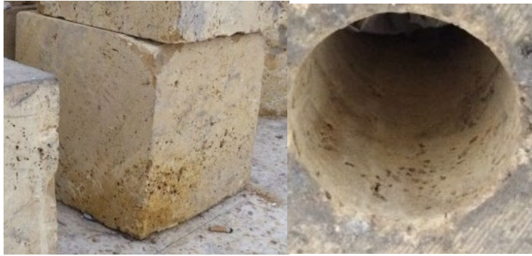
Şekil 2.4. Numunelerin alındığı 30x30x30 cm ölçülerindeki bloklar ve NX çapında karot alınmış blok
