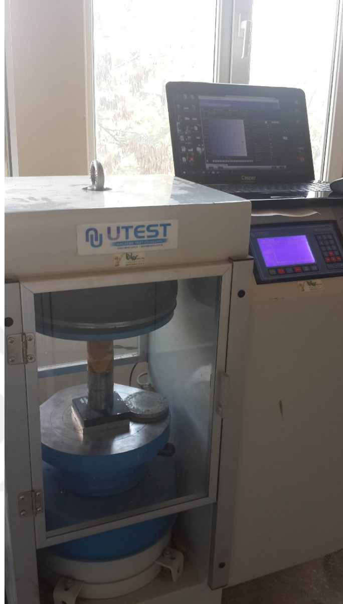
Şekil 2.12. Tek Eksenli Serbest Basınç Deneyi
