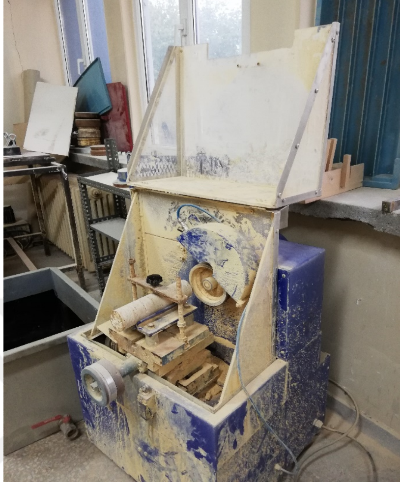
Şekil 2.7. Karot numunenin aşındırma makinesi ile düzeltilmesi
