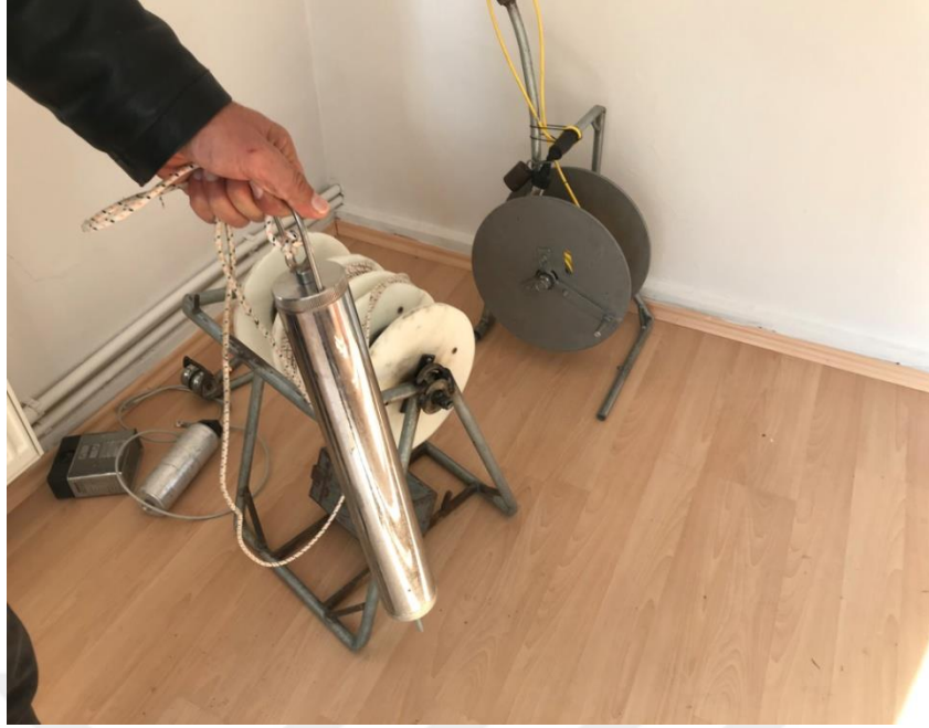
Şekil 4.1 Arazi tipi çelik numune alma haznesi.
