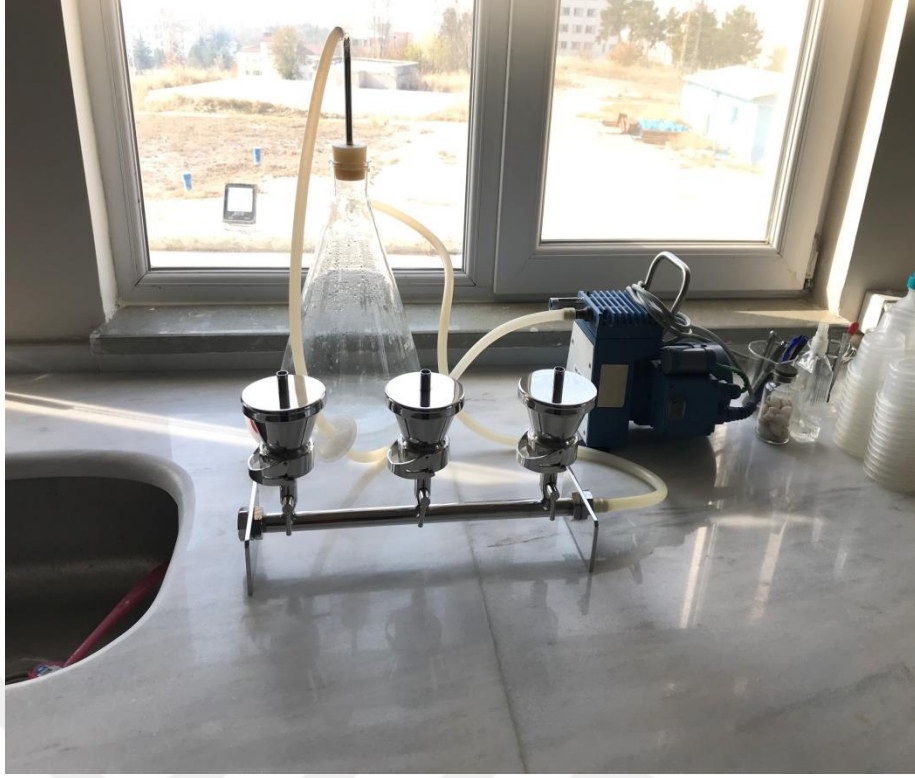
Şekil 4.7 Membran Filtrasyon yöntemi.
