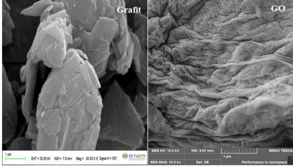
Şekil 3.6 Toz grafit ve GO'ya ait SEM görüntüsü
