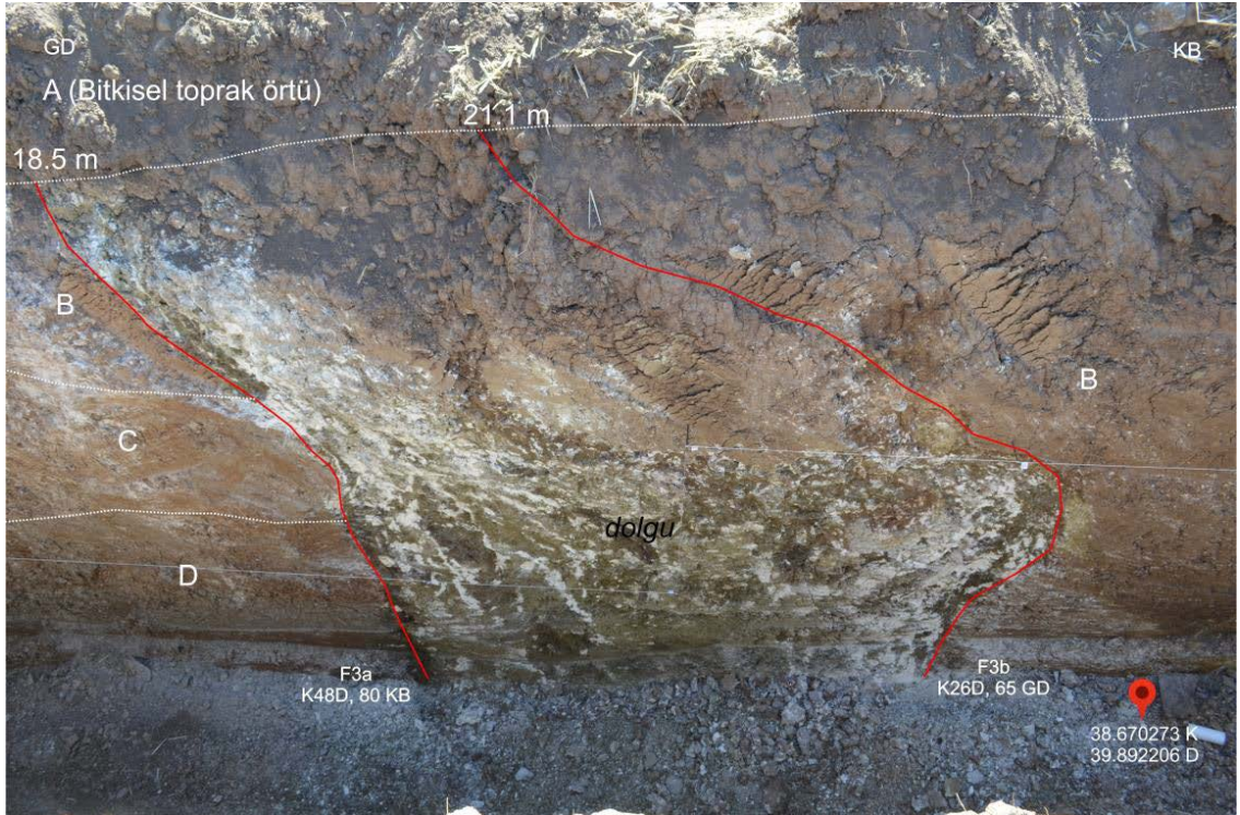
Şekil 5.29 Palu 4 Hendeğinde gözlenen F3a ve F3b faylarını gösterir fotoğraf. Stratigrafik seviyeler için Şekil 5.32'deki loga bakınız.
