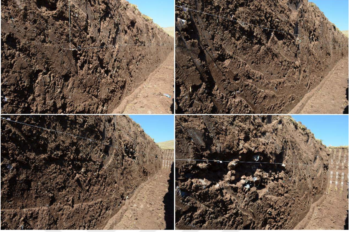
Şekil 5.20 Palu 3 Hendeğinin stratigrafisini gösterir fotoğraflar.
