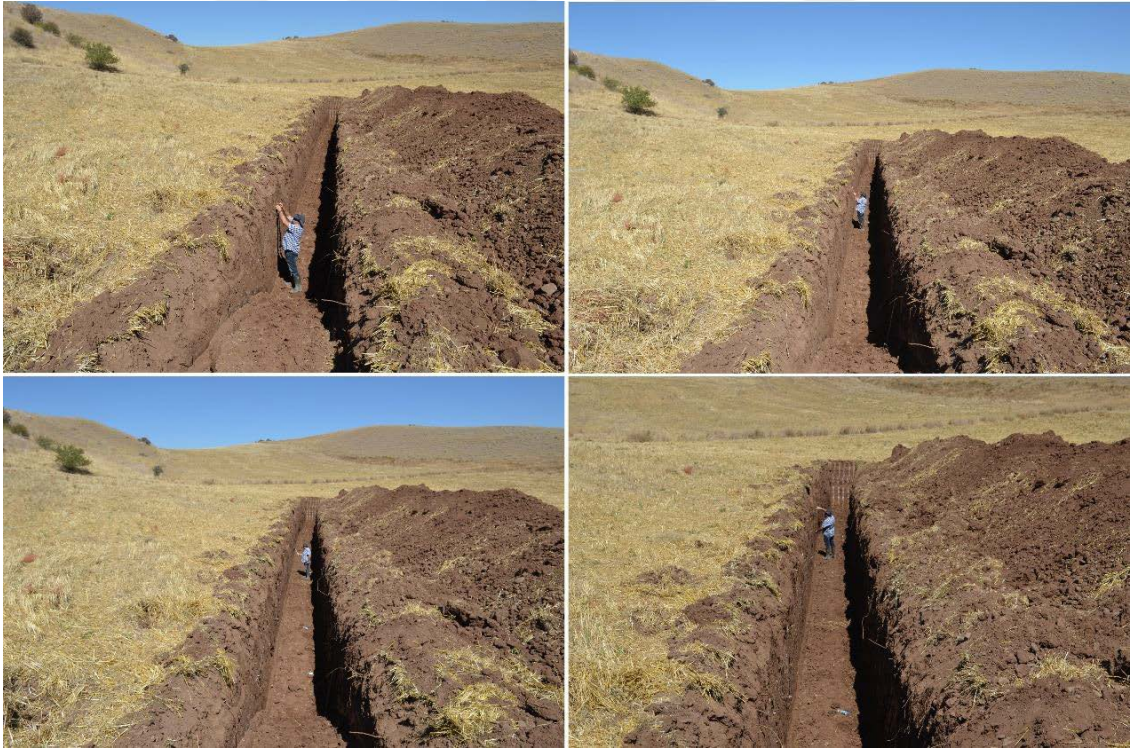
Şekil 5.18 Palu 3 Hendeğinin güneybatı duvarında yapılan temizlik ve loglama çalışmasından görüntüler.
