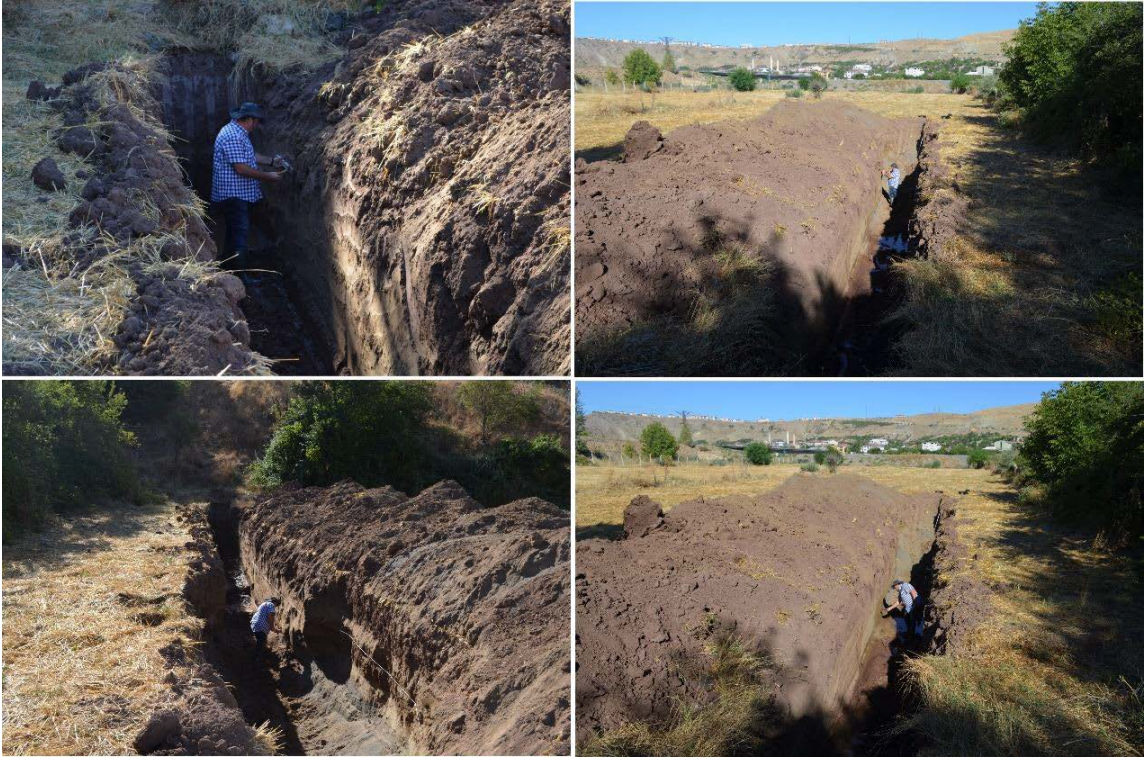
Şekil 5.5 Palu 1 Hendeğinin güneybatı duvarında yapılan temizlik ve loglama çalışmasından görüntüler.
