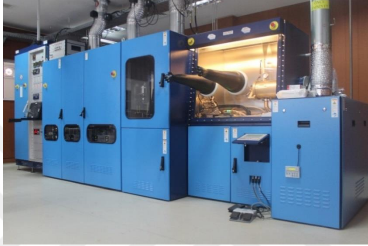
Şekil 4.1 Cumhuriyet Üniversitesi Nanofotonik Uygulama ve Araştırma Merkezinde kurulu olan hem AsH_3-PH_3 tabanlı hemde Nitrat tabanlı MOCVD sistemi
