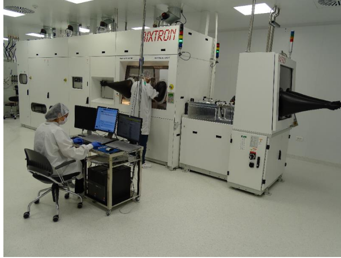
Şekil 4.2 ERMAKSAN Optoelektronik Uygulama ve Araştırma Merkezinde kurulu olan AsH_3-PH_3 tabanlı MOCVD sistemi
