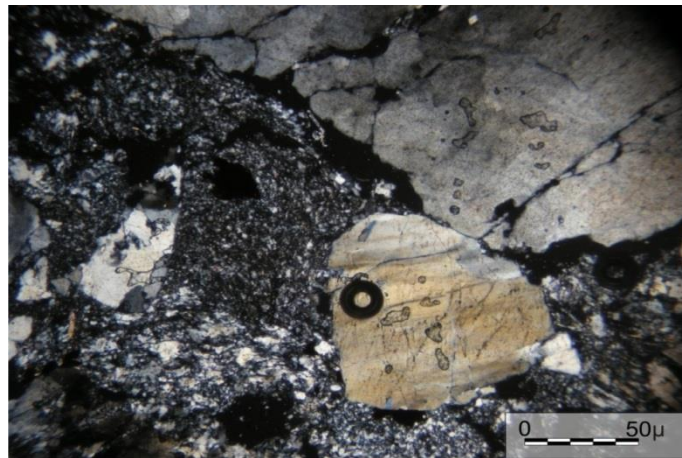
Şekil 5.14. Bayırköy Formasyonuna ait konglomera örneğinin mikroskop görüntüsü (MA-19.1).
