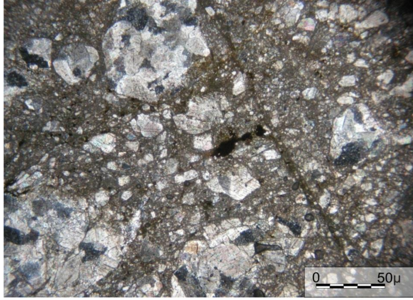
Şekil 5.24. Bilecik Kireçtaşına ait breşik kireçtaşı örneğinin mikroskop görüntüsü (MA-80).
