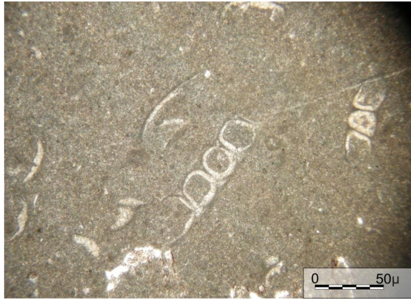
Şekil 5.20. Bilecik Kireçtaşına ait mikritik kireçtaşı örneğinin mikroskop görüntüsü (MA-79).
