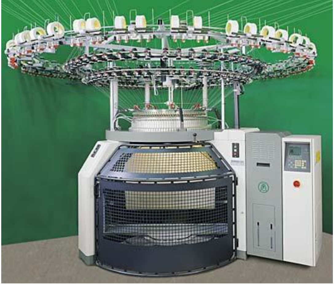
Şekil 19: Mayer & Cie Relanit 3.2 II makinesinin genel görünüşü
