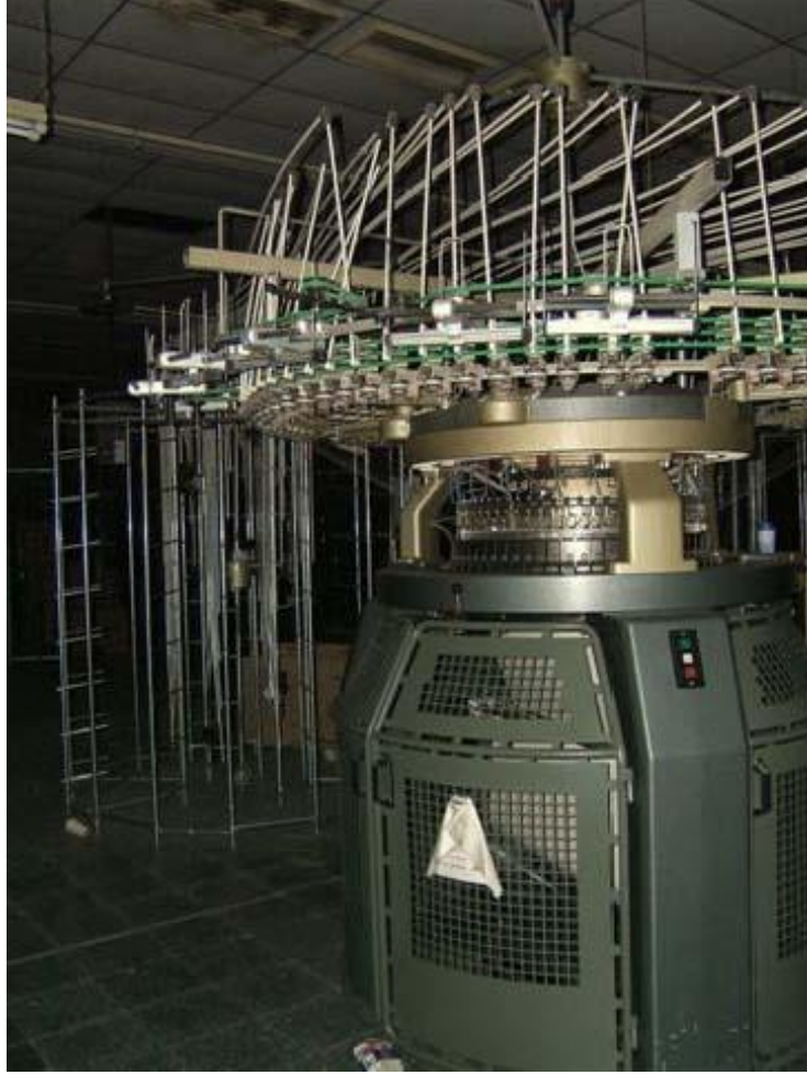
Şekil 20: Mayer & Cie Relanit 4 II makinesinin genel görünüşü
