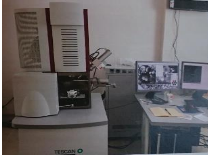
Şekil 14 Mira 3XMU-Tescan Taramalı Elektron Mikroskobu
