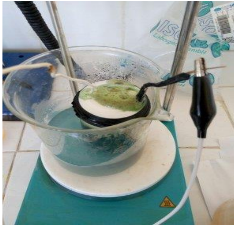
Şekil 20 Bakır soketin 70 °C'de ethaline ile yapılan deneyde köpürmenin gösterimi
