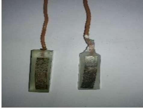
Şekil 5 Epoksiye alınmış kesici soket ve 316L paslanmaz çelik katot
