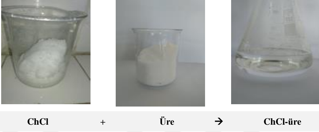
Şekil 9 Kolin klorür – üre iyonik sıvısının hazırlanışı
