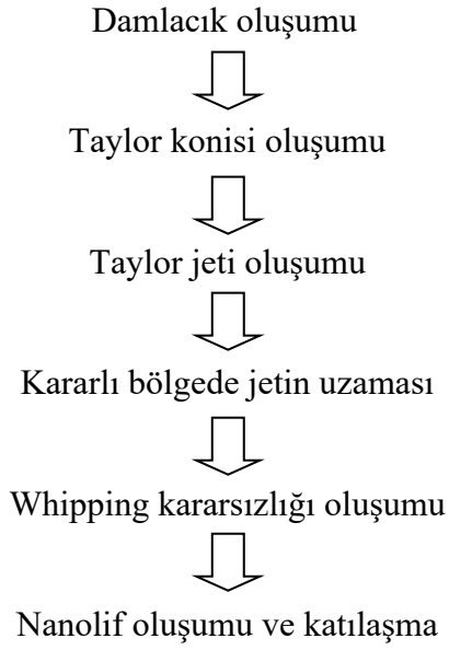
Şekil 1.2 Elektro-Eğirme İşleminin Aşamaları
