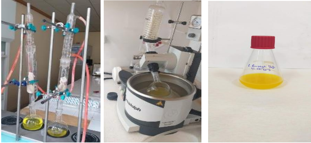
Şekil 2.1 Soxhlet düzeneği – Rotary Evaporatör ve elde edilen buğday ruşeym yağı
