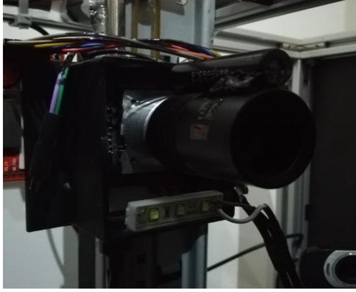
Şekil 3.2. Çizgi tarama sensörü, lazer ve ışık kaynağı
