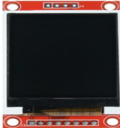
Şekil 2.8. 1.8 İnç 128 x 160 LCD modül ve bağlantı yapısı
