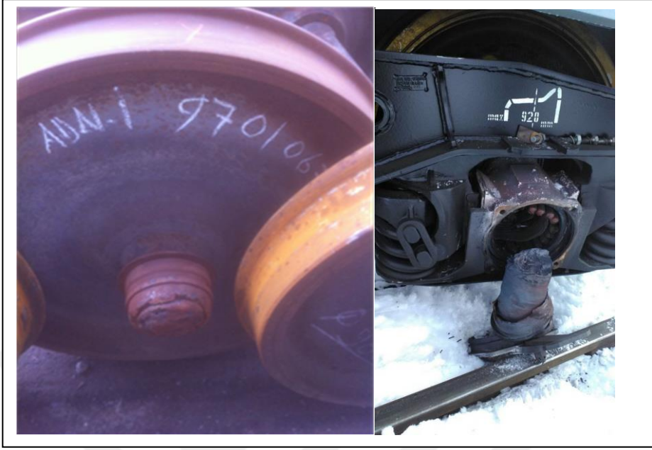
Şekil 5.5 Rulman Isınması Sonucu Turyon Kısmı Kopmuş Tekerlek (TÜDEMSAŞ)
