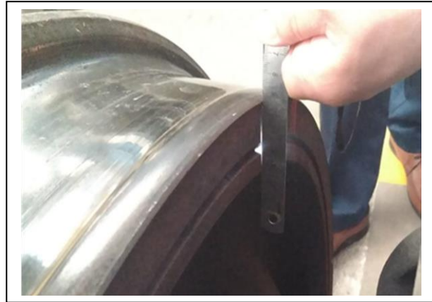
Şekil 7.1 Isıl Sebeplerle Kalıcı Şekil Değişimine Uğramış Tekerlek
