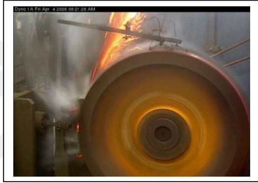
Şekil 6.3 Dinamometre ile Yapılan Frenleme Testi [42],[17]
