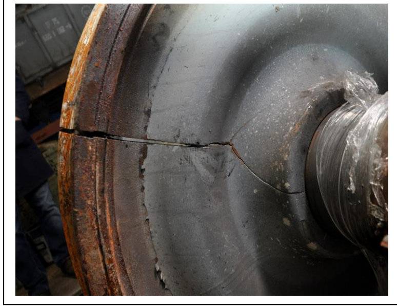
Şekil 5.8 Tekerlekte Tipik Bir Kırılma (TÜDEMSAŞ)
