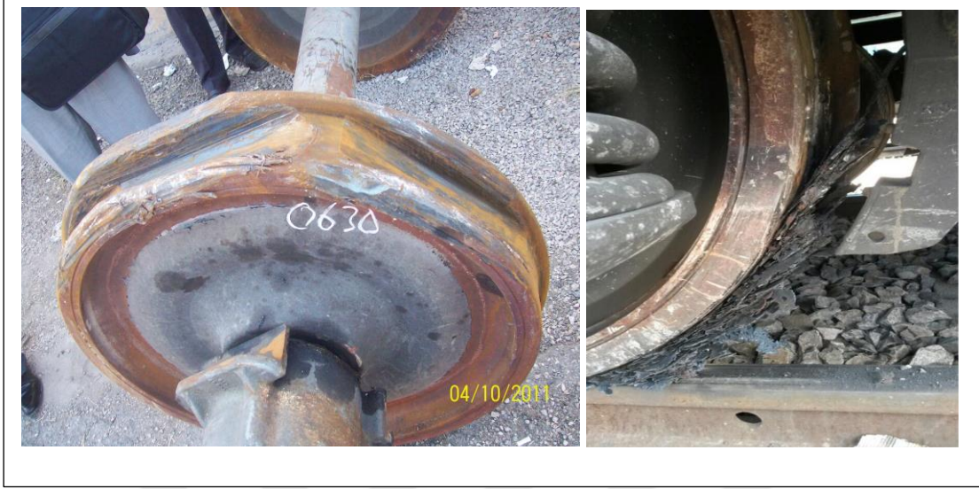
Şekil 5.13 El Freni Çözülmemiş Vagona Oluşan Tekerlek Hasarı
