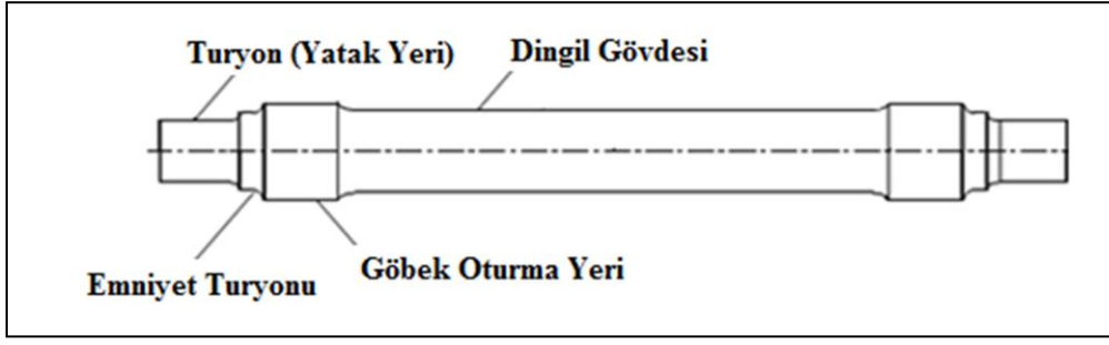
Şekil 3.3 Yük Vagonu Tekerlek Setinde Kullanılan Dingil [18]
