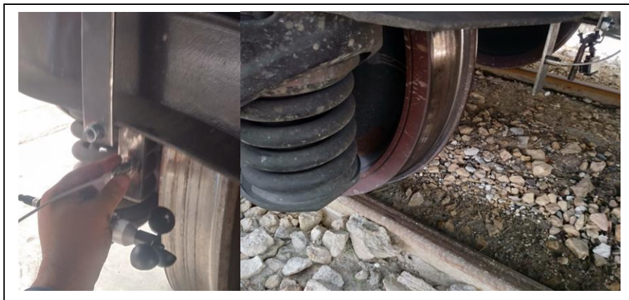
Şekil 7.11 Sıcaklık ve Rüzgar Hızı Sensörlerinin Bojiye Yerleştirilmesi
