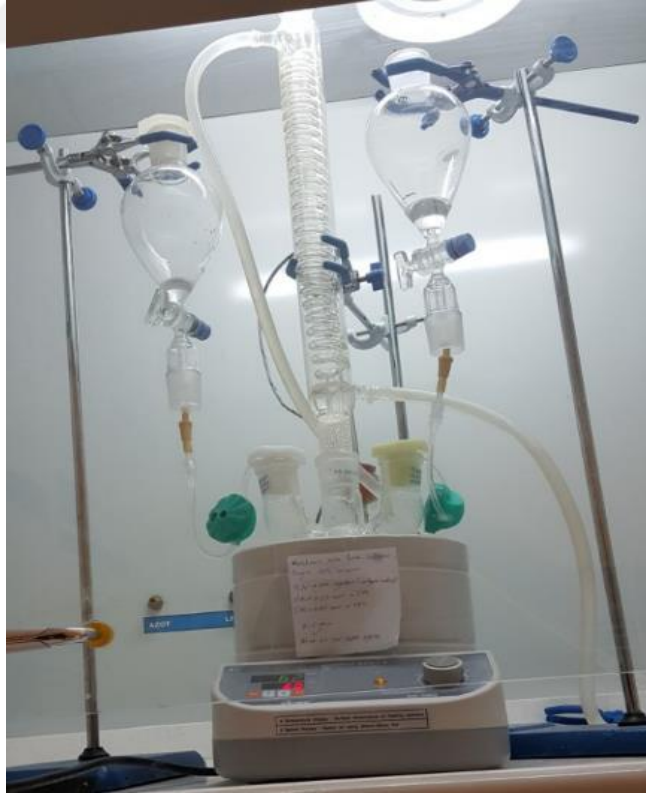
Şekil 3.4 PCEs sentezinde kullanılan deney düzeneği
