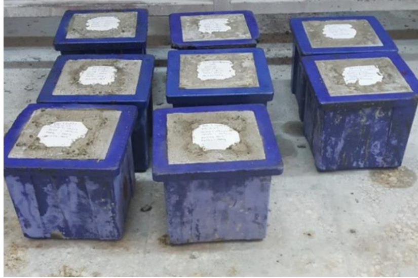
Şekil 3.7 Kalıplara alınmış beton numuneleri
