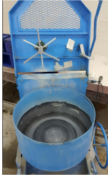
Şekil 3.5 Beton karıştırmada kullanılan pan tipi beton mikseri
