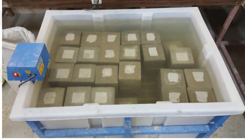
Şekil 3.8 Beton kür havuzu
