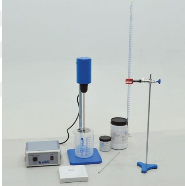
Şekil 3.9 Metilen mavisi deney seti
