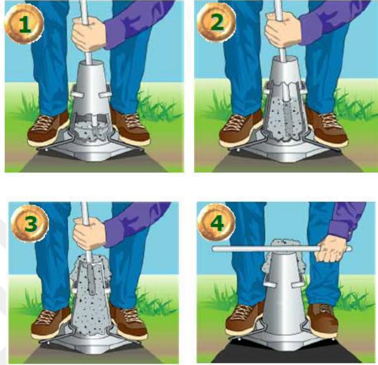
Şekil 2.4 Betonu numunesini sıkıştırma basamakları
