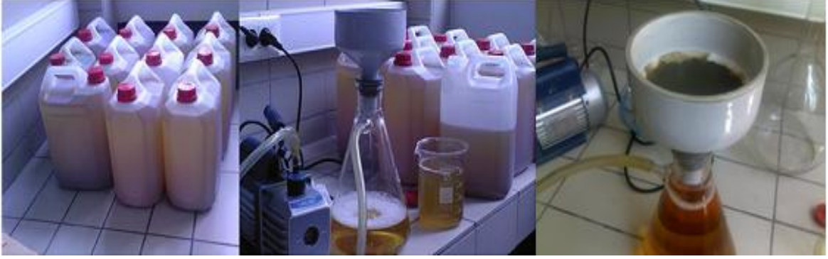
Şekil 4.1 : Temin edilen atık rodyum kaplama çözeltileri ve filtreleme işlemi.
