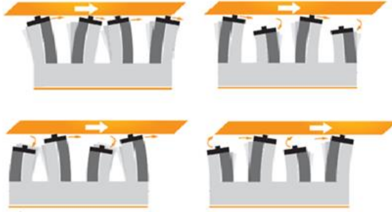
Şekil 1.3.2.1. Piezobacak çalışma prensibi
