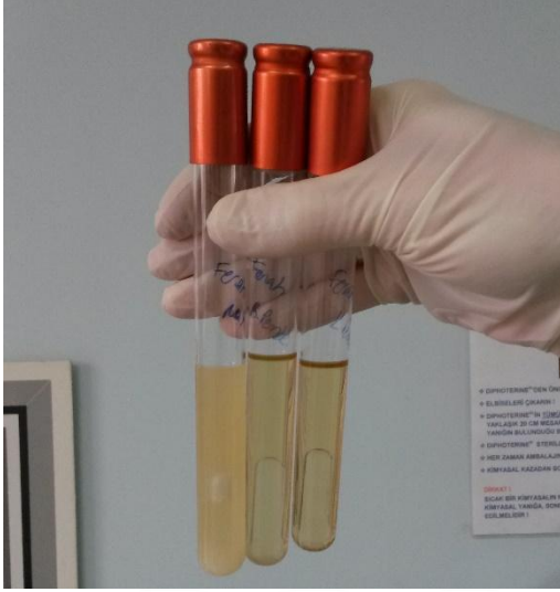
Şekil 2.18. EC Broth kültüründe pozitif ve negatif tüpler
