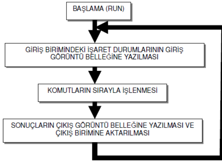
Şekil 1.7. PLC programının yürütülmesi [17]
