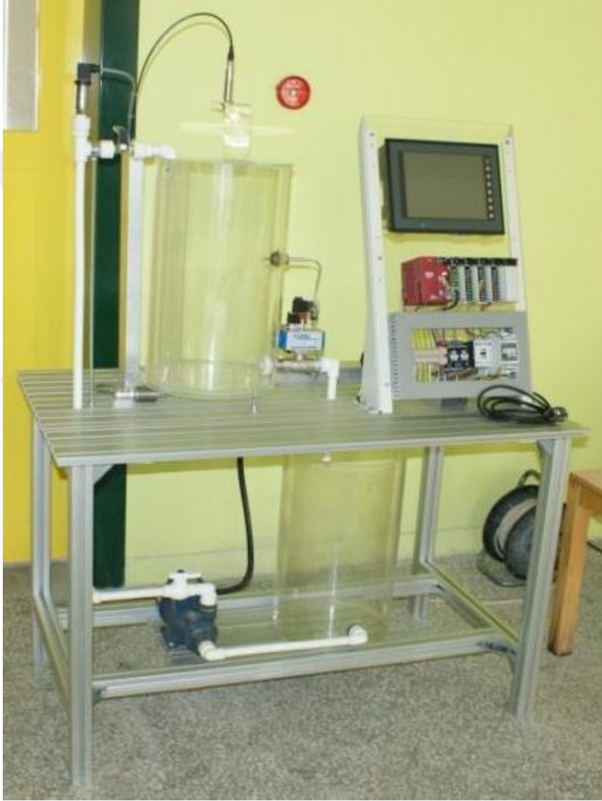
Şekil 2.1. Prototip endüstriyel sıvı tankı sistemi
