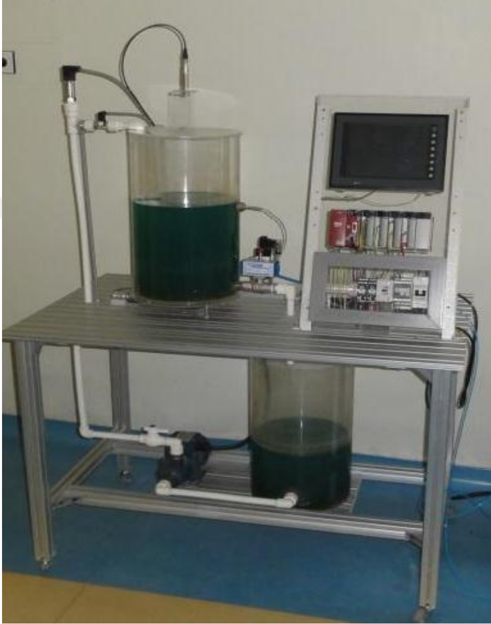
Şekil 2.2. Prototip endüstriyel sıvı tankı uygulama testi
