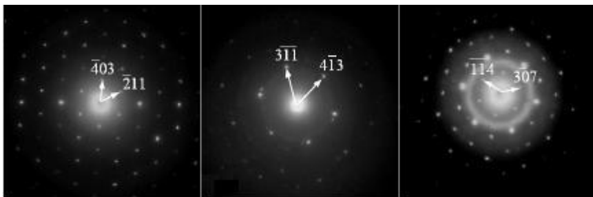
Şekil 2.16: \beta -FePc, \beta -PbPc ve \beta -CoPc komplekslerinin X-ışını kırınım modelleri
