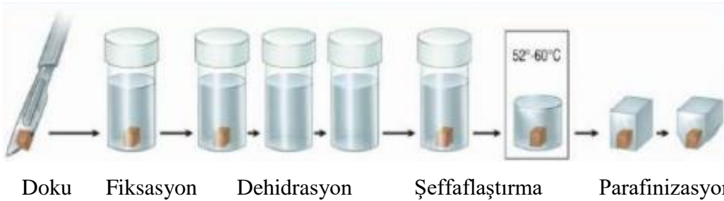
Şekil 2.6. Histolojik kesit alırken doku, fiksasyon, dehidratasyon, şeffaflaştırma ve parafinizasyonu temsil eden şematik gösterim.
