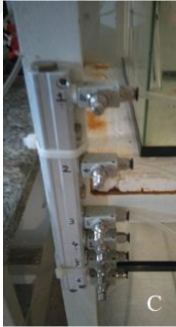
Şekil 2.2. Deney için dizeyn edilen CO 2 düzeneği. A. Sudaki pH'ı CO 2 tüpü yardımı ile istenilen pH'ı sabit tutan controller, B. CO 2 tüpü, C. CO 2 'i akvaryumlara dağıtan pnömatik hortumlar ve dağıtıcı, D. CO 2 'i akvaryuma veren difüzör.
