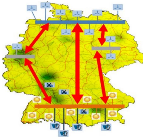
Şekil 2.9. Almanya iletim hattının güçlendirilmesi gereken güzergahlar [102]
