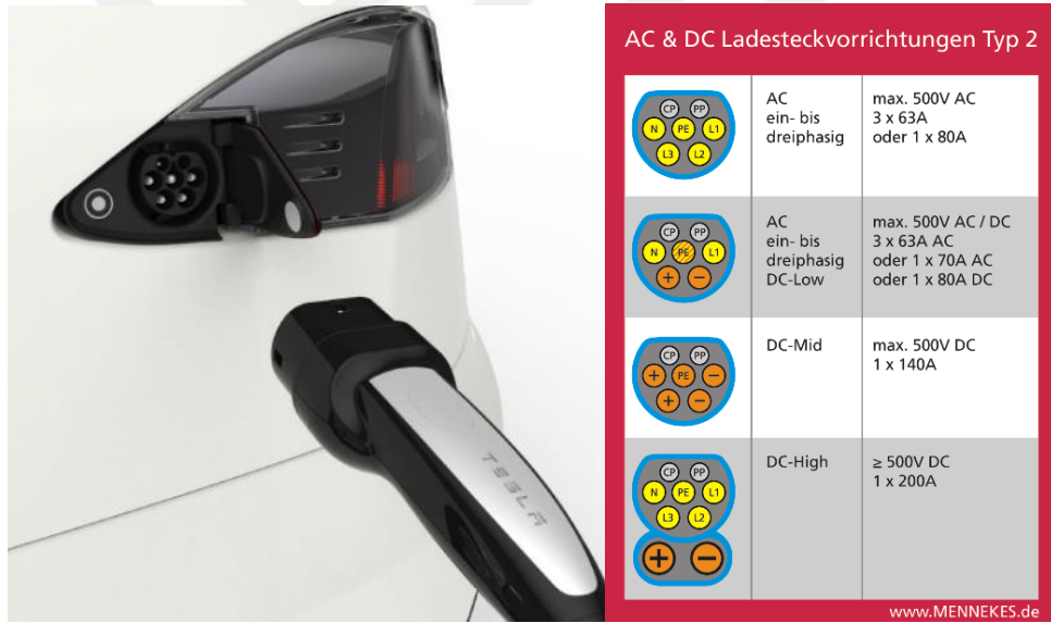
Şekil 2.18. Elektrikli araç batarya beslemesi bağlantısı [32]
