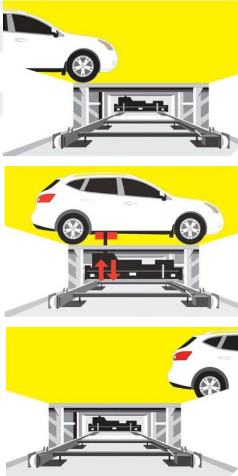
Şekil 2.38. Batarya değişim sistemi uygulaması [62]
