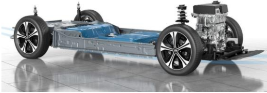
Şekil 2.36. Nissan Leaf bataryası [15]
