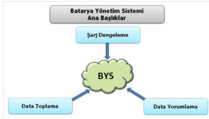
Şekil 2.20. Batarya yönetim sistemi diyagramı [37]
