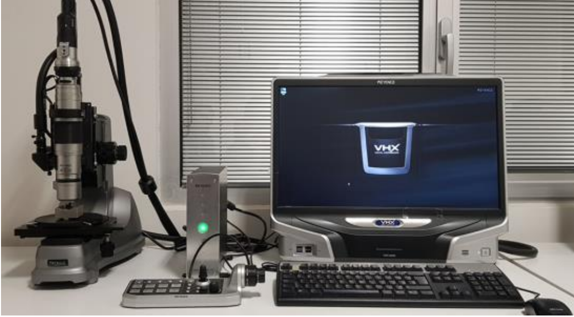
Şekil 2.11. Dijital optik mikroskop [56]
