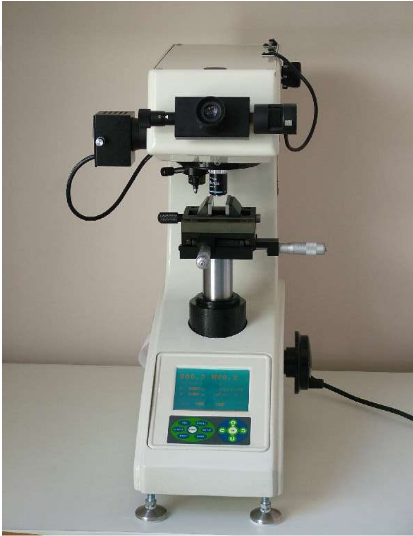
Resim 11. Wilson Wolpert 402 MVD Mechanical Instrument Hardness Tester (Amerika) Cihazı
