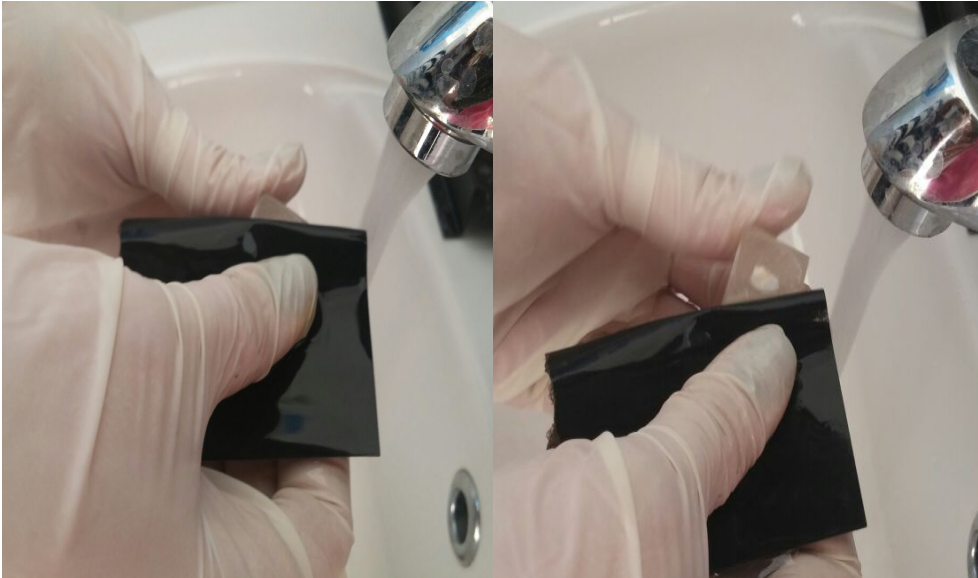
Resim 6. Mine örneklerinin silikon karbid kağıtlar ile zımparalanması
