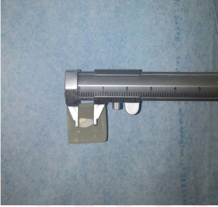
Resim 3. 6 x 3 x 3 mm boyutlarında mine örnekleri
