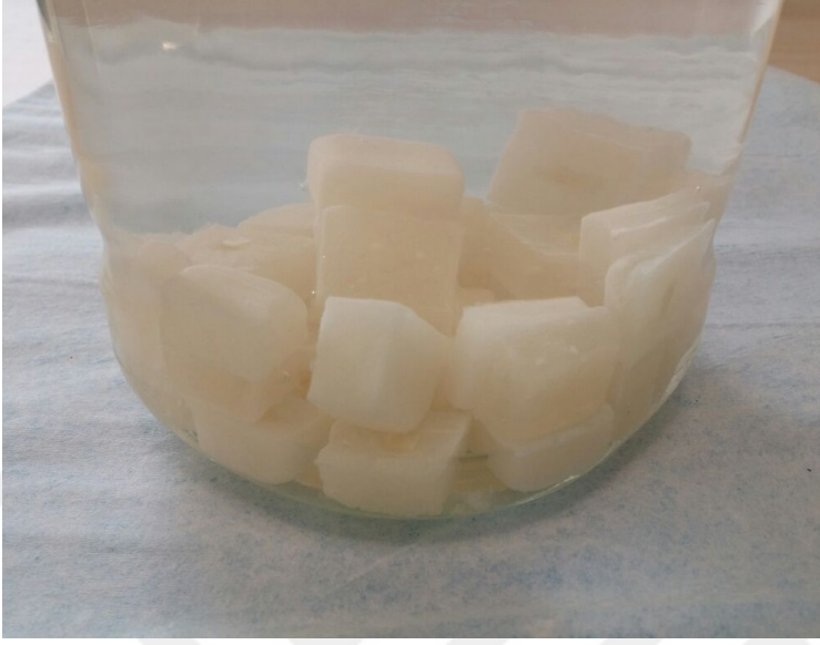
Resim 5. Mine örneklerinin deiyonize suda oda sıcaklığında bekletilmesi
