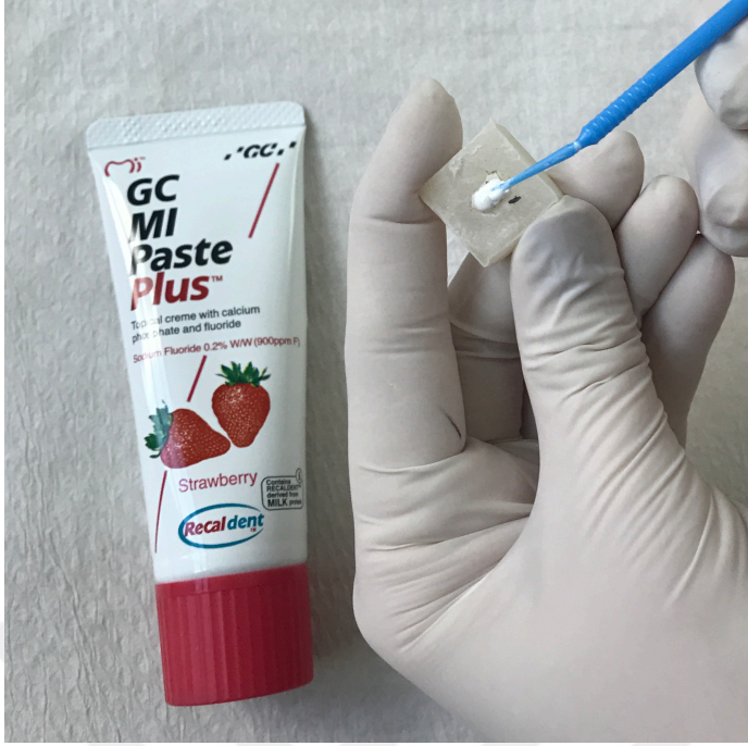
Resim 18. Bond fırçası yardımıyla remineralizasyon ajanının mine örneklerine uygulanması
