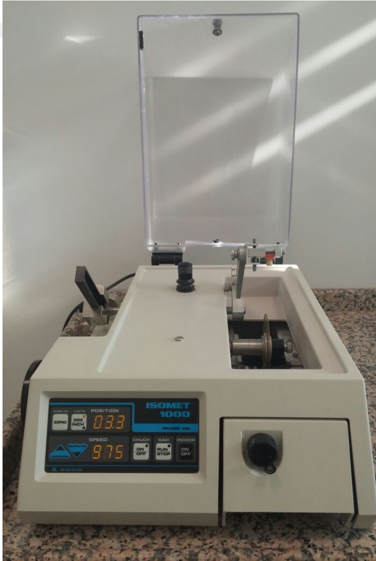
Resim 1. ISOMET 1000 Precision Cutter Kesim cihazı (Buehler Lake Bluff, Illinois, ABD)
