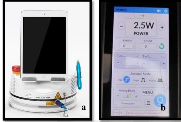
Resim 5.5. (a) Diode lazer cihazı (b) Frenektomi operasyonu sırasında Diode lazer cihazının parametreleri.
