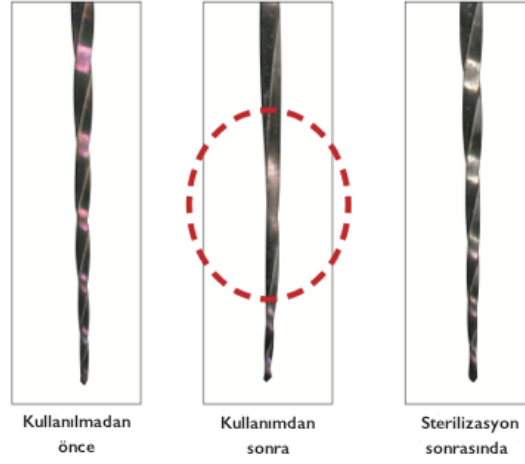
Şekil 8. Hyflex CM sisteminin sterilizasyon sonrası orijinal haline geri dönmesi
