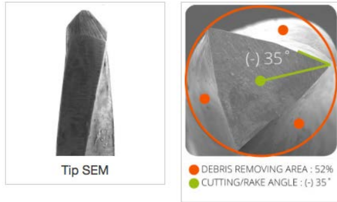
Şekil 9. Hyflex CM SEM görüntüleri
