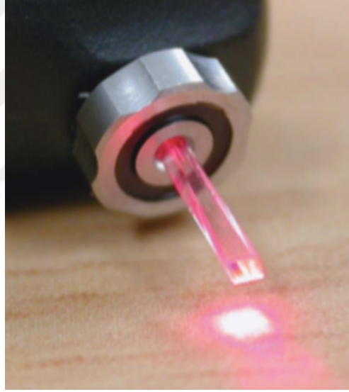
Resim 12: DIAGNOdent™ Pen cihazının düz yüzeylerde kullanılmak üzere geliştirilen A ucu
