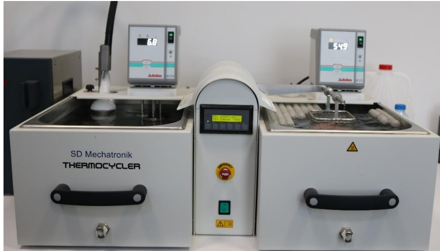
Resim 3.21. Termal siklus cihazı (THE-1100, SD Mechatronik, Almanya)
