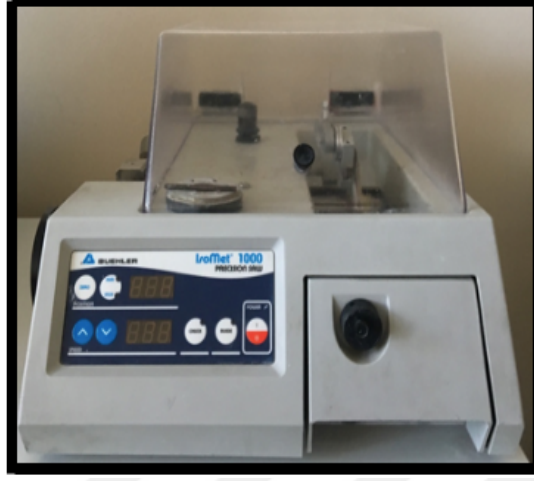
Resim 11: Hassas kesim cihazı (Buehler, İsoMet 1000 Precision Cutter, İllinois, Amerika)
