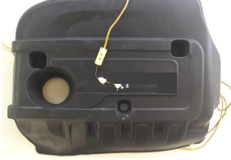
Şekil 2.21 : Motor sıcaklık testi ölçüm noktaları.
