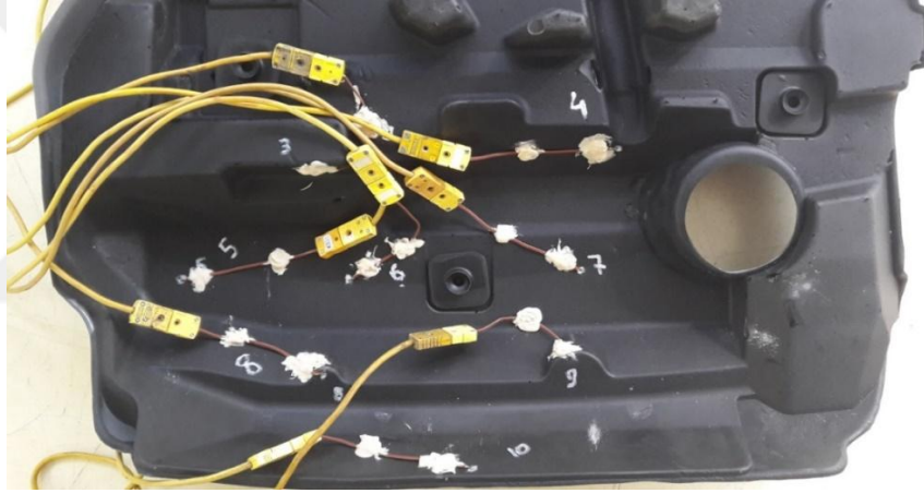
Şekil 2.22 : Motor sıcaklık testi ölçüm noktaları.
