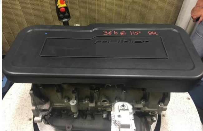
Şekil 2.28 : Dikey yönlü test bankosu üzerine montajlı motor üstü kapak.
