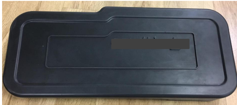
Şekil 3.12 : Tek yoğunluklu poliüretan motor kapağı termal şok testi sonucu görünümü.
