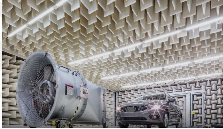
Şekil 2.17 : Akustik testler için kullanılan tam yalıtımlı oda. [23].
