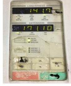
Şekil 3.14 : Çıkma yükü test sonucu.
