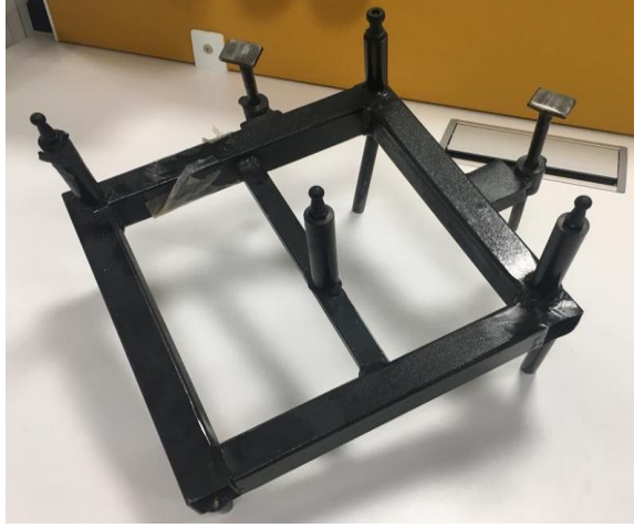
Şekil 2.23 : Araç üzerindeki konumu simule eden motor kapağı fikstürü.
