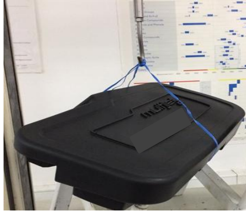
Şekil 2.26 : Çıkma yükü test bankosu.
