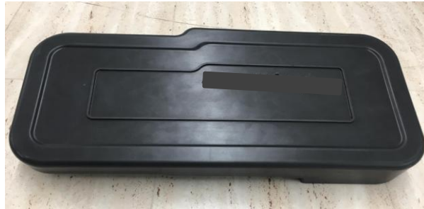
Şekil 3.8 : Tek Yoğunluklu poliüretan motor kapağı termal çevrim testi sonucu görünümü.
