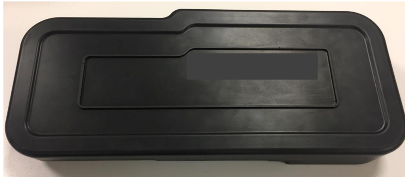
Şekil 3.10 : Tek yoğunluklu poliüretan motor kapağı ısıl yaşlandırma testi sonucu görünümü.
