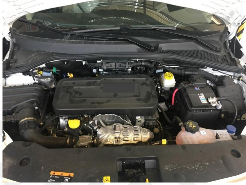
Şekil 2.29 : Gerçek yol testi aracına takılmış tek yoğunluklu poliüretan motor üst kapağı.
