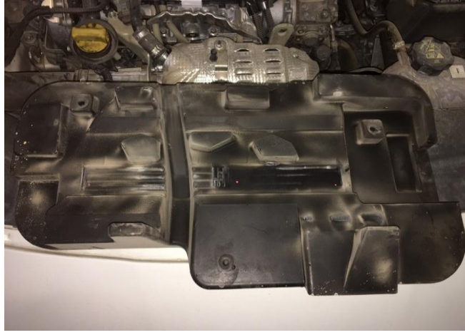
Şekil 3.16 : Tek yoğunluklu PÜ motor üstü kapak gerçek yol test sonucu görüntüsü. (Alt yüzey).
