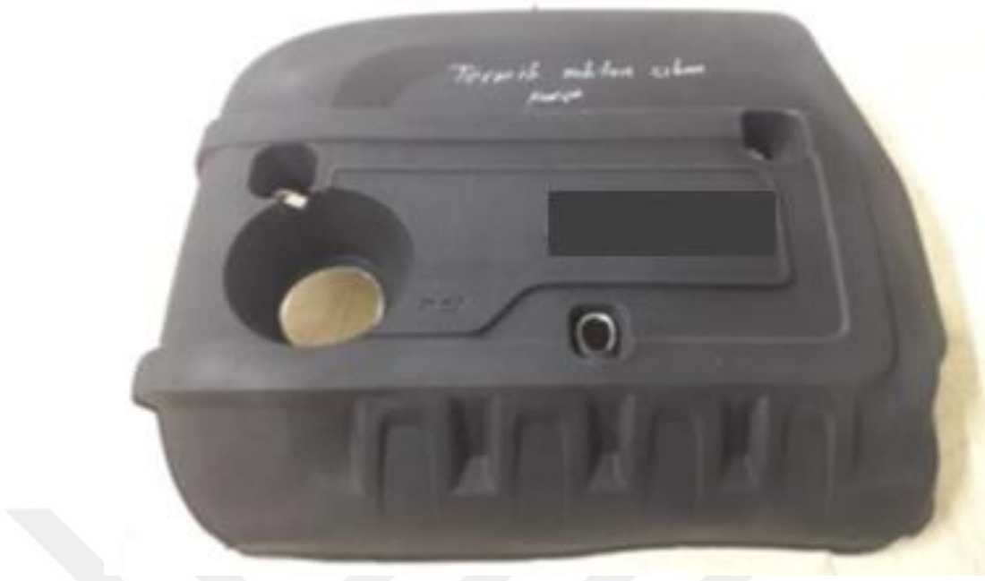
Şekil 3.13 : Çift yoğunluklu poliüretan motor kapağı termal şok testi sonucu görünümü.
