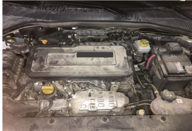
Şekil 3.15 : Tek yoğunluklu PÜ motor üstü kapak gerçek yol test sonucu görüntüsü. (Üst yüzey).
