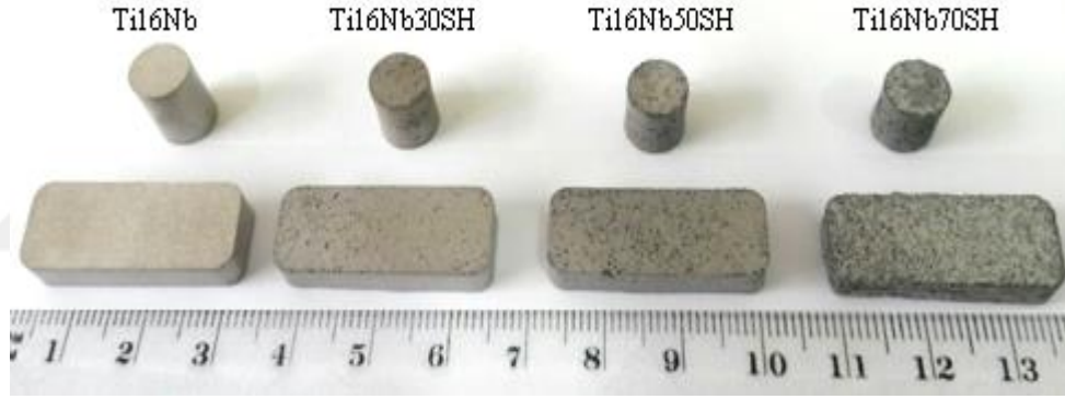
řekil 7.6. Farklı miktarlarda bořluk tutucu ieren sinterlenmiř Ti16Nb alařımları.
