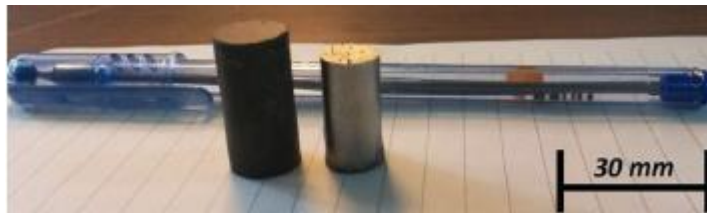
Şekil 7.5. Enjeksiyon kalıplama ve sinterleme sonrası basma testi numunesi görüntüsü.
