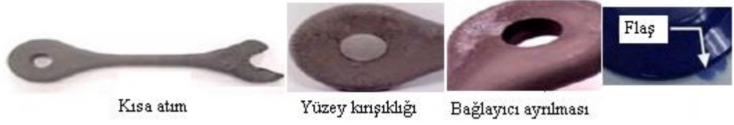
Şekil 4.2. Enjeksiyon kalıplama kusurları [27].
