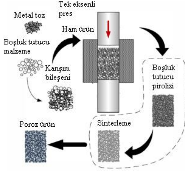
Şekil 5.1. Boşluk tutucu yöntemi üretim şeması [32].
