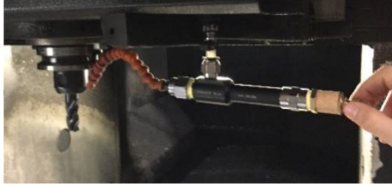
Şekil 4.6. Soğutma nozulu yardımı ile işleme düzeneği
