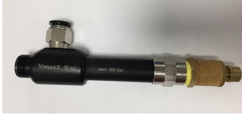
Şekil 3.2.İsı pompası prensibi ile çalışan VimaxX R-30 soğutucu
