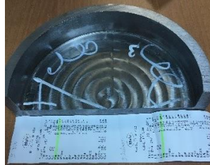
Şekil 4.7. Şartlandırılmış hava kullanılarak işleme sonucu takım aşınmasının makro resmi (a), takım sıcaklığı (b), yüzey pürüzlülüğü (c)
