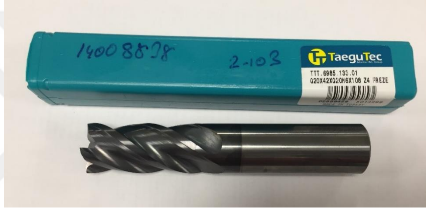
Şekil 3.3.TaeguTec Ø20 parmak freze
