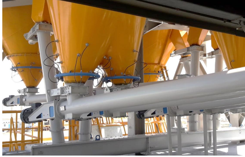
Şekil 2.8. Farklı kimyasalların helezonlar ile taşınması ve 5 adet helezonun başka bir helezonu beslemesi
