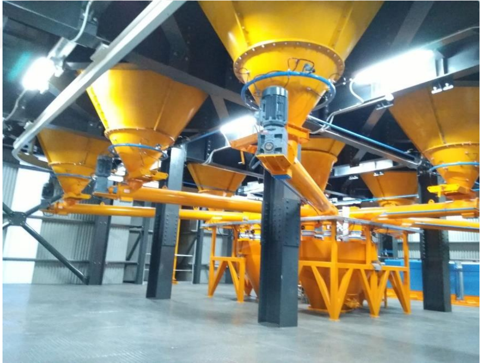
Şekil 2.5. Çeşitli kimyasalların helezonlar yardımı ile siloya taşınması
