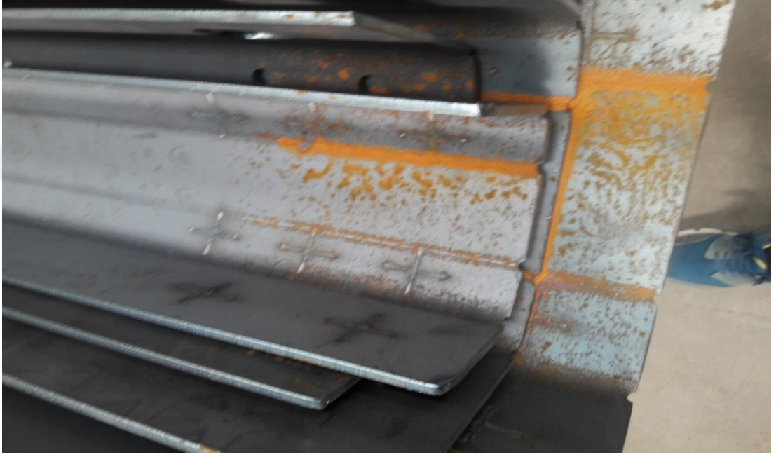
Şekil 5.6. Sepetli platform bomlarının abkant büküm ile şekillendirilmesi.
