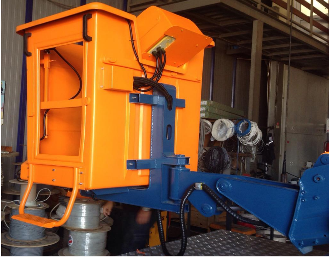
Şekil 3.7. Sepetli platform polyester sepet kullanımı.
