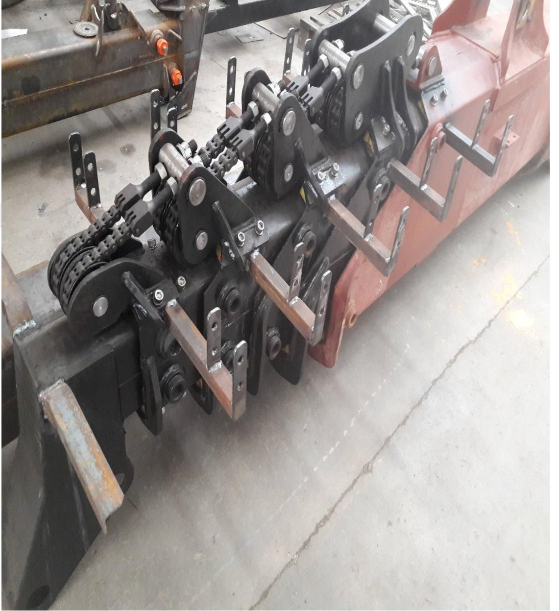
Şekil 3.5. Sepetli platform ara montajı tamamlanmış bom mekanizması.
