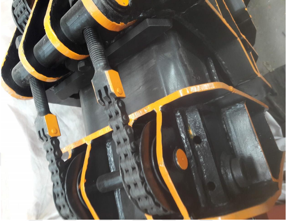
Şekil 7.2. Sepetli platform boamları üzerinde farklı zincir boyutlarının kullanımı.
