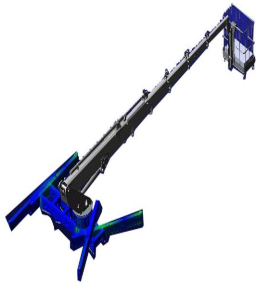
Şekil 8.7. Sepetli platform şasisi yanal çalışma sınırına göre yapısal analizi.
