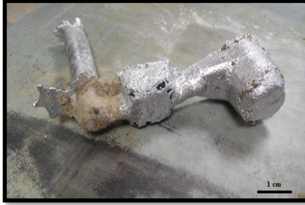
Şekil 7.20. Tek katmanlı alüminyum infiltrate edilmiş kompozit malzeme
