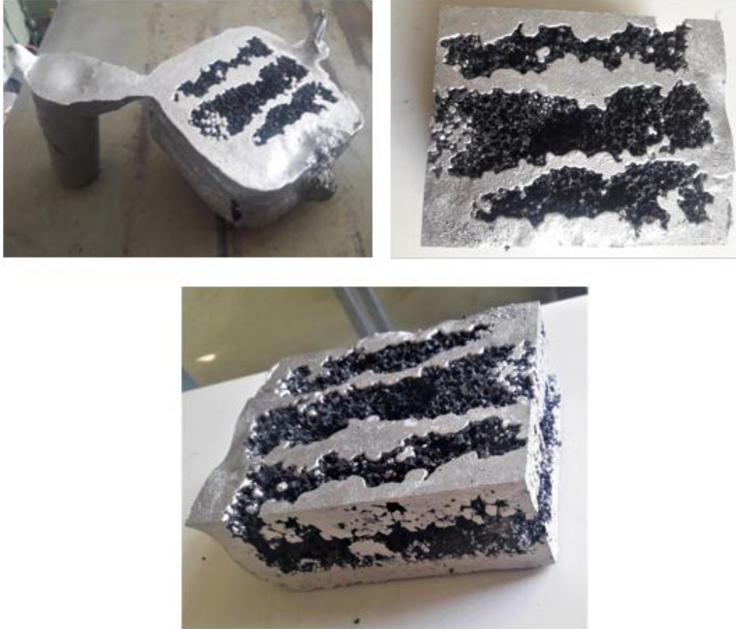
Şekil 7.23. Çift katmanlı alüminyum infiltre edilmiş fonksiyonel derecelendirilmiş kompozit malzeme-2.döküm
