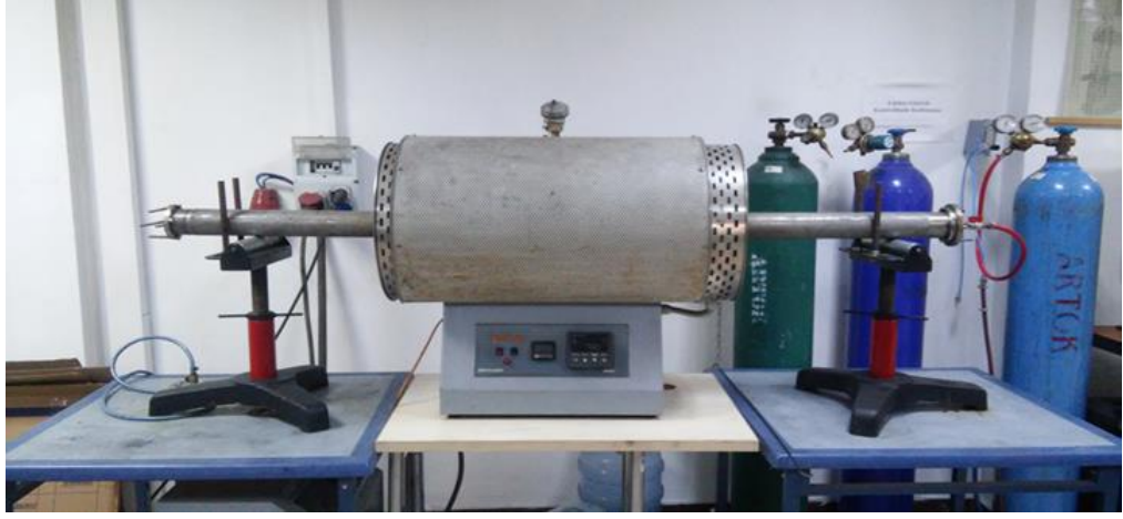
Şekil 6.7. Atmosfer kontrollü yatay tüp fırını
