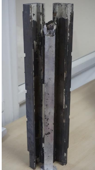
Şekil 3.28. Döküm sonrası açılan kalıbın ve kontrollü katılaşma numunesinin görüntüsü
