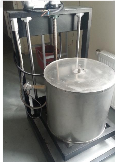
Şekil 3.12. Kontrollü katılaştırma öncesi metal ergitmek için kullanılacak elektrik direnç ergitme fırını
