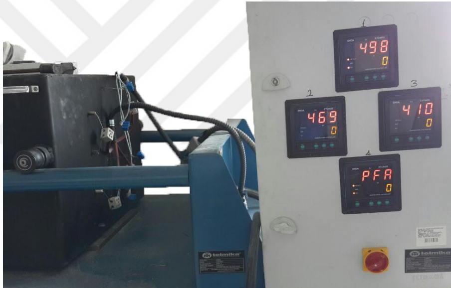
Şekil 3.26. Termokapıl bağlantısında kopukluk olması durumunda görülen hata
