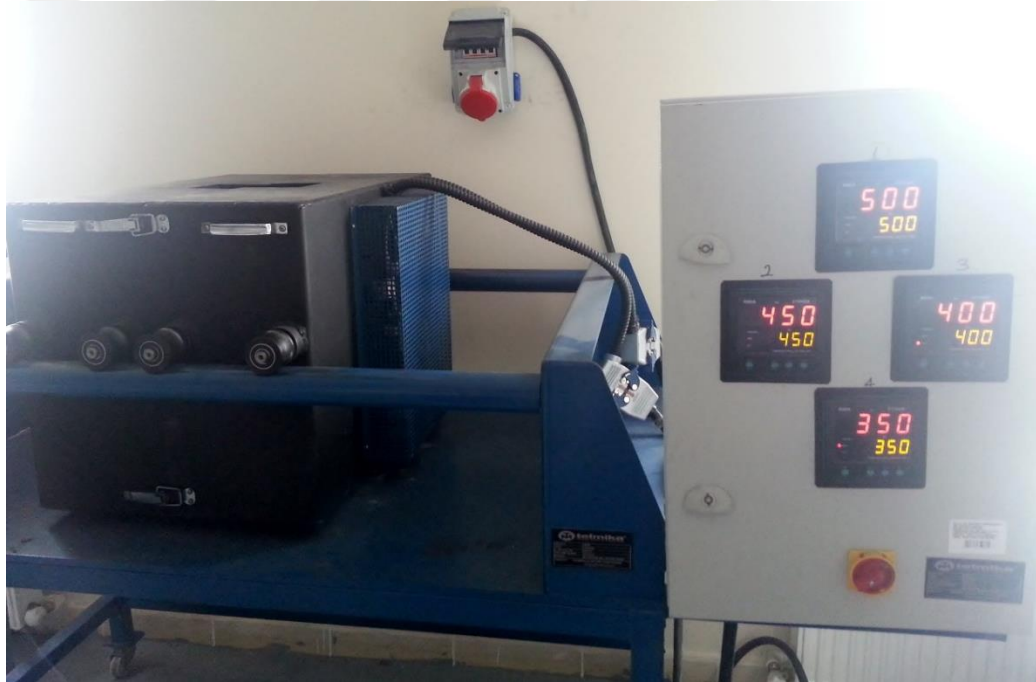
Şekil 3.14. Fırının her bir bölgesinin ayrı bir sıcaklıkta tutulması
