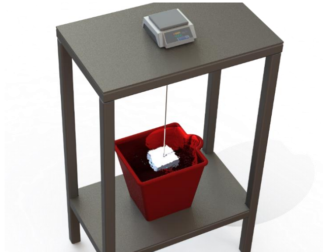
Şekil 3.36. Yoğunluk ölçümlerinin yapıldığı Arşimet düzeneği
