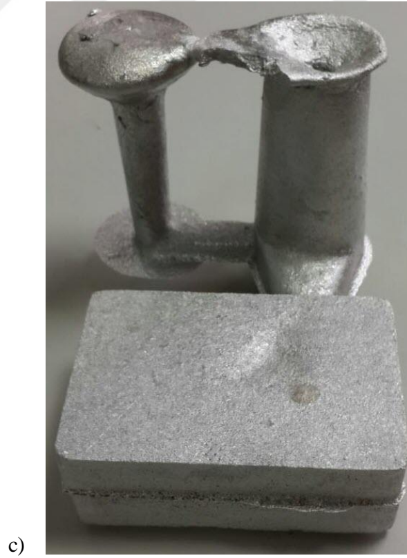
Şekil 4.37. Doğrulama deneyinde kullanılan modelin, a) teknik resmi, b) montaj görünümü, c) döküm hali
