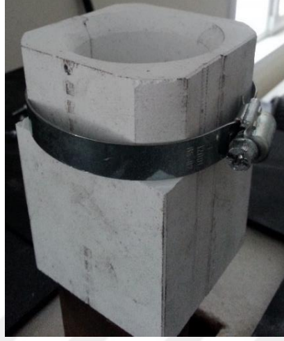
Şekil 3.27. Kalıp üzerine yerleştirilen döküş haznesi
