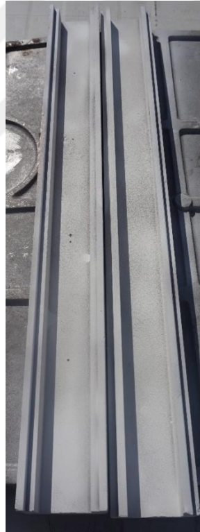
Şekil 3.25. Kokil kalıp boyası ile kaplanmış kalıp
