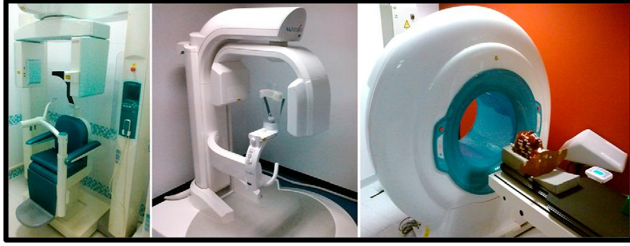
Şekil 17: Farklı çeşitlerdeki KIBT gantrileri; solda oturur hasta pozisyonu (3D Accuitomo® 170; J. Morita, Kyoto, Japan), ortada ayakta hasta pozisyonu (WhiteFox®; Acteon Group, M'erignac, France), sağda yatar konumda hasta pozisyonu (NewTom® 5G, QR srl, Verona, Italy).
