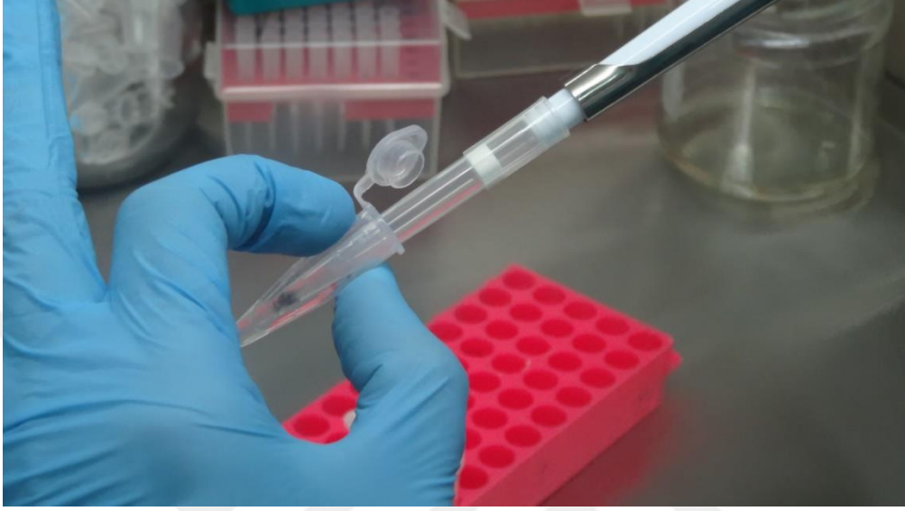
Resim 5.18A. Numunelerin eppendorf tüp içerisinde alınması
