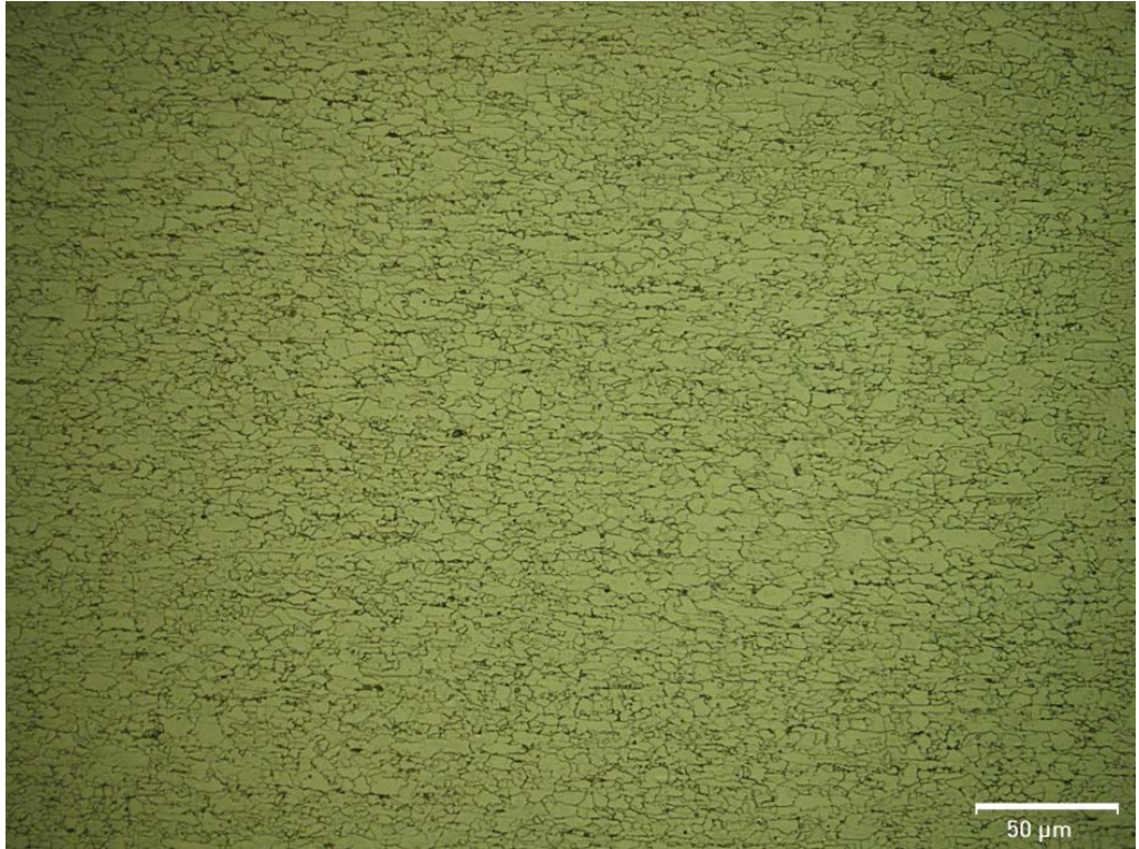
Şekil 67. Tavlama dövdürölmüş yan yüzeye ait optik mikroskop görüntüsü, 1000x büyütme
