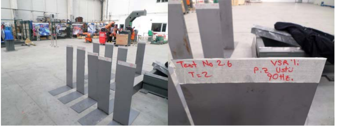
Şekil 51. VSR'li robotla kaynak uygulama örnekleri
