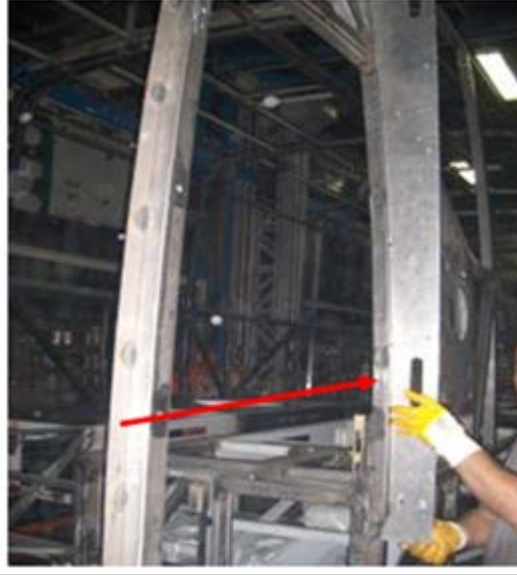
řekil 32. n ve arka direklerin eđimlerinin řablon ile kontrol
