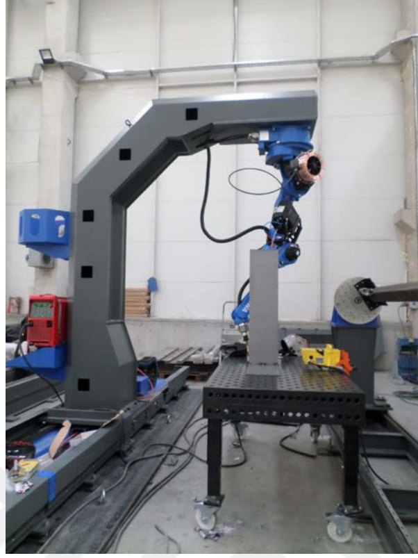
Şekil 50. VSR'li robotla kaynak uygulaması
