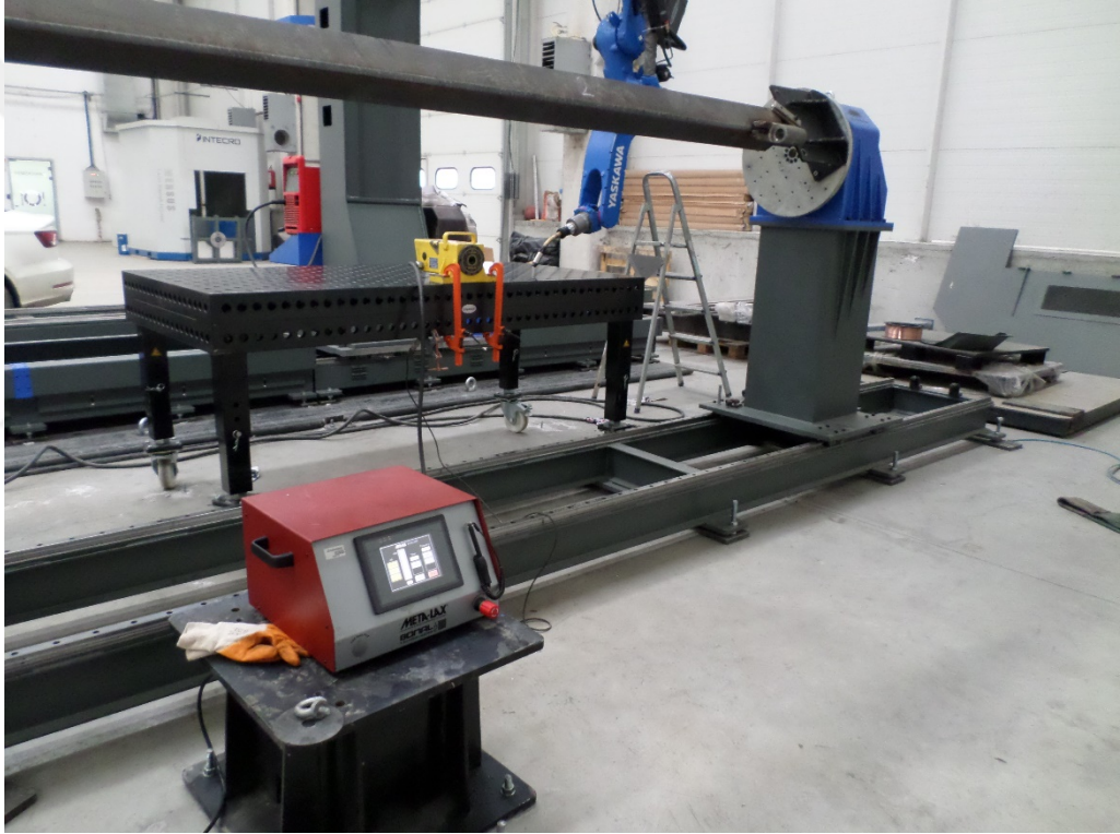
Şekil 49. VSR'li robotla kaynak uygulaması
