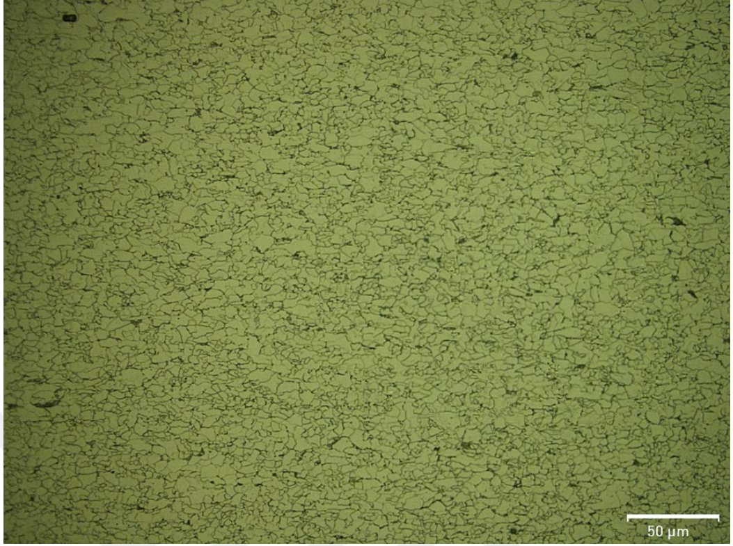
Şekil 72. İşlem görmemiş profilin yan yüzeyine(yüzey normaline dik) ait optik mikroskop görüntüsü 1000x
