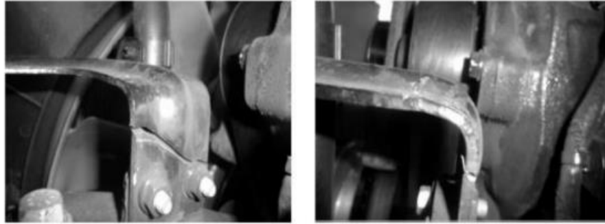
Şekil 2.10. Kaynak bölgesinde oluşan yetersiz füzyondan dolayı kırılan ürün (Davut ve diğerleri, 2015)
