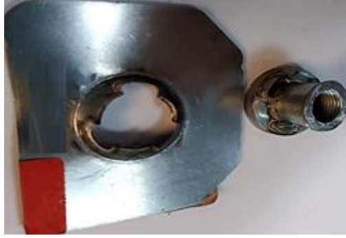
Şekil 4.11. Kaynak parametreleri akım 18 kA, kaynak süresi 20 per, tutma süresi 25 per olan numunenin koparma testi sonucu oluşan hasar görseli
