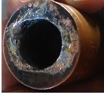
Şekil 4.15. Kaynak parametreleri akım 22 kA, kaynak süresi 20 per, tutma süresi 5 per olan numunenin kaynağı esnasında alt elektrotun iş parçası ile alaşımlaşması
