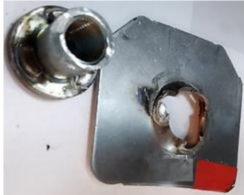
Şekil 4.12. Kaynak parametreleri akım 20 kA, kaynak süresi 25 per, tutma süresi 25 per olan numunenin koparma testi sonucu oluşan hasar görseli
