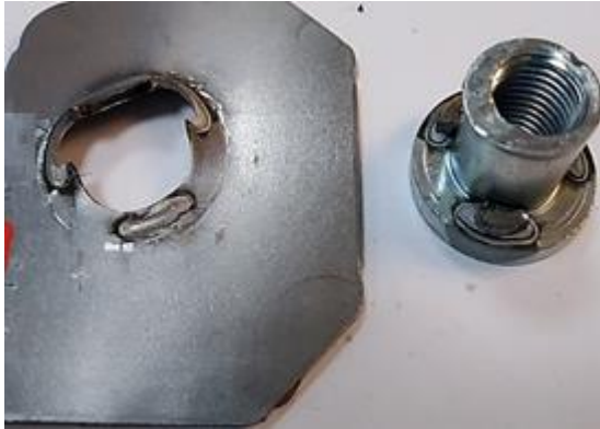
Şekil 4.10. Kaynak parametreleri akım 16 kA, kaynak süresi 15 per, tutma süresi 15 per olan numunenin koparma testi sonucu oluşan hasar görseli
