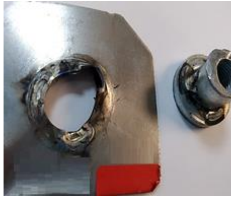
Şekil 4.14. Kaynak parametreleri akım 22 kA, kaynak süresi 10 per, tutma süresi 10 per olan numunenin koparma testi sonucu oluşan hasar görseli
