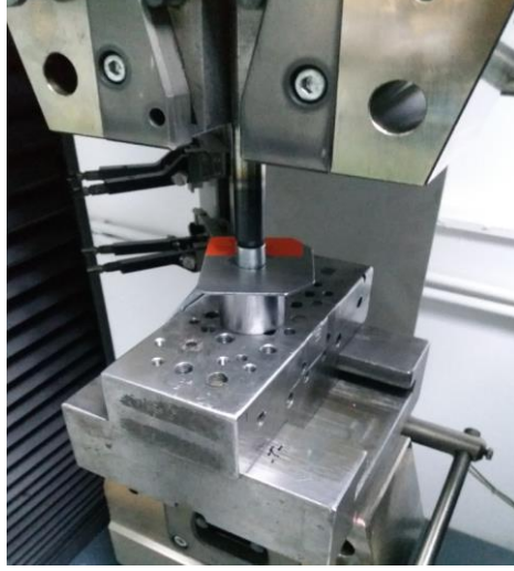
Şekil 3.14. Kaynak koparma testi uygulama görseli
