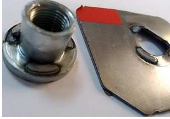
Şekil 4.9. Kaynak parametreleri akım 14 kA, kaynak süresi 25 per, tutma süresi 10 per olan numunenin koparma testi sonucu oluşan hasar görseli
