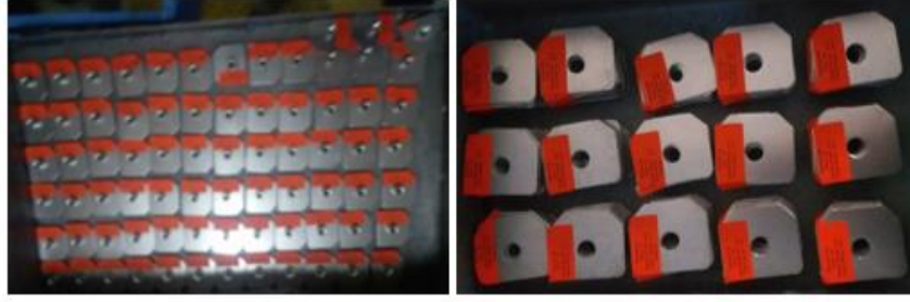
Şekil 3.15. Kaynak işlemine hazır etiketlenmiş numuneler
