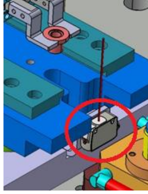
Görsel 8. Kalıp içerisine yerleştirilen mesafe ölçer sensör
