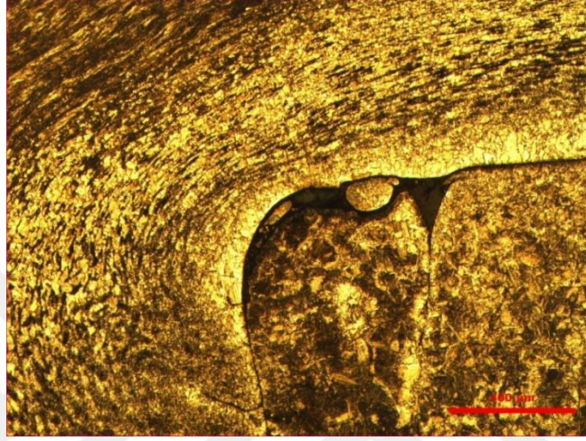
Şekil 4.50. 136.2 numaralı numunede fıskırma sonucu oluşan çatlak ve çapaklanma-2 (50x)
