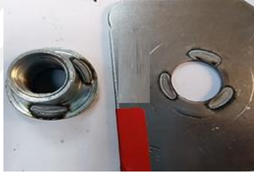
Şekil 4.8. Kaynak parametreleri akımı 12 kA, kaynak süresi 10 per, tutma süresi 25 per olan numunenin koparma testi sonucu oluşan hasar görseli
