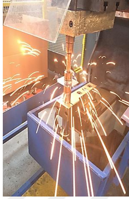
Şekil 4.13. Kaynak parametreleri akım 20 kA, kaynak süresi 20 per, tutma süresi 25 per olan numunenin kaynak işlemi esnasında oluşan fişkırmaya görseli
