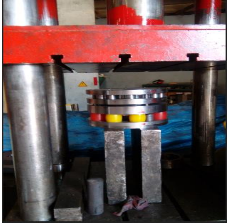
Şekil 3.18. Tasarlanan kalıbın prese yerleştirilmesi sırasında elde edilen görüntü
