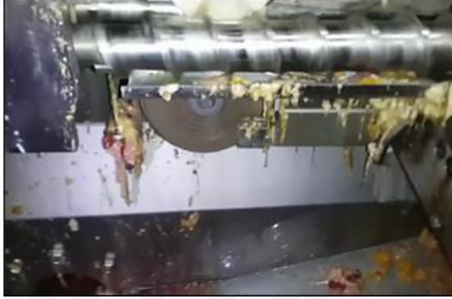
Şekil 4.1. Bıçağın taşlık kesimi sırasındaki görünümü
