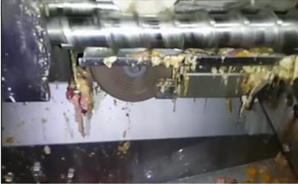
Şekil 3.41. Biyonik dairesel bıçağın makine üzerindeki konumu
