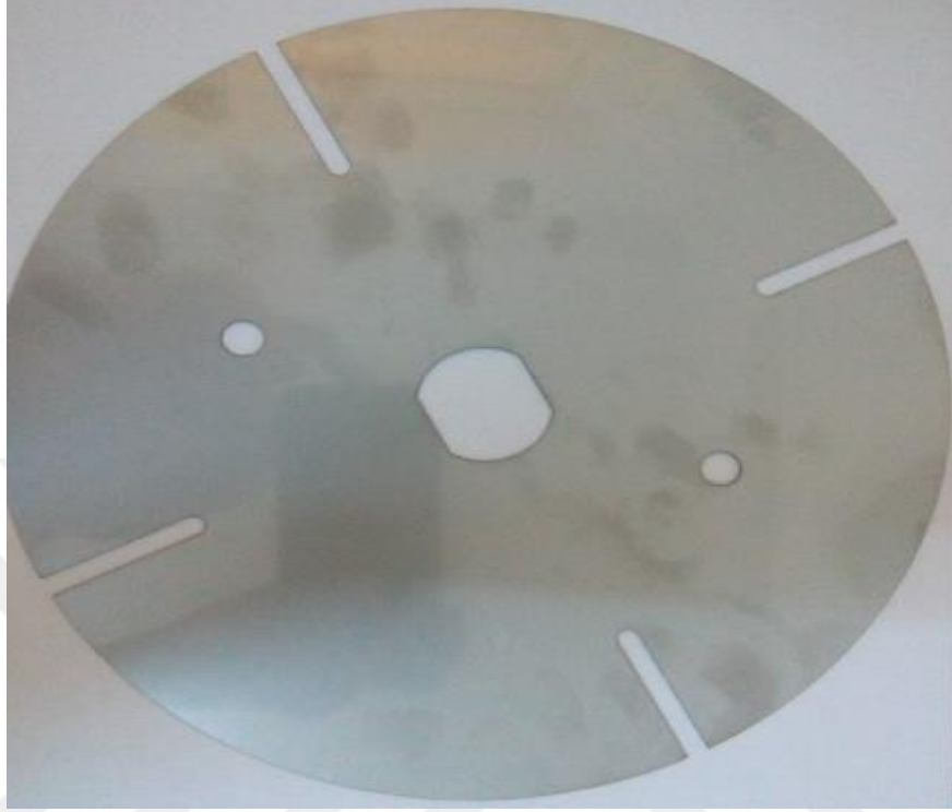
Şekil 3.15. 1.4301 (SAE 304) malzemeden hazırlanmış basım öncesi biyonik dairesel bıçak
