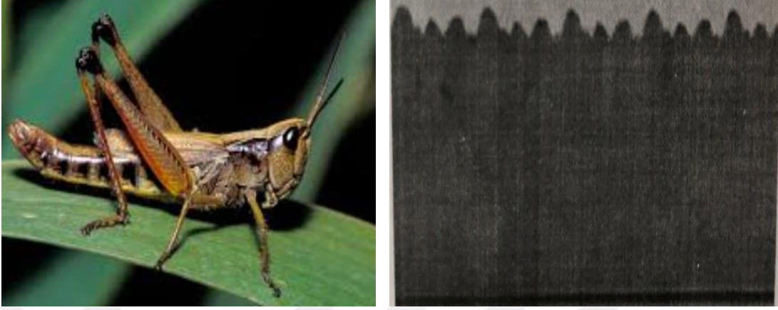
Şekil 2.11. Çekirgenin kesici dişlerinden esinlenerek tasarlanan bıçak (Honglei, Changying, Zhihong, & Gang, 2013)
