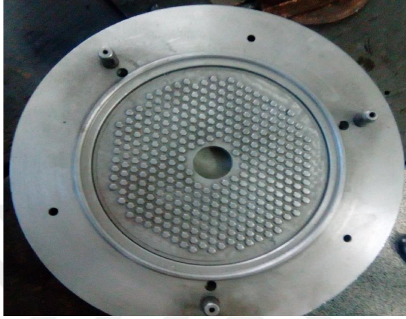
Şekil 3.17. Üretimi yapılan kalıbın erkek yüzey görüntüsü
