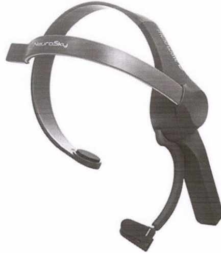
Şekil 3.2: Neurosky mindwave EEG algılayıcı kulaklık [43].
