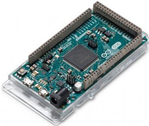
Şekil 3.5: Arduino DUE kontrol kartı [46].
