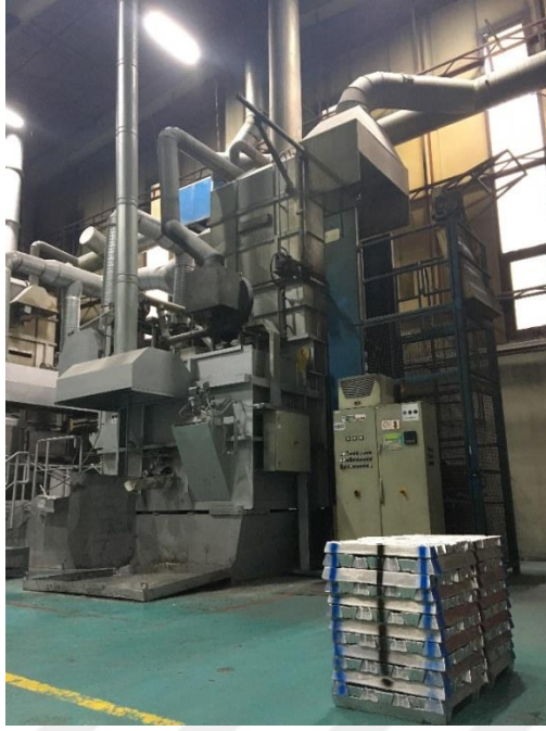
Şekil 5.4: Strikowestofen ergitme fırını
