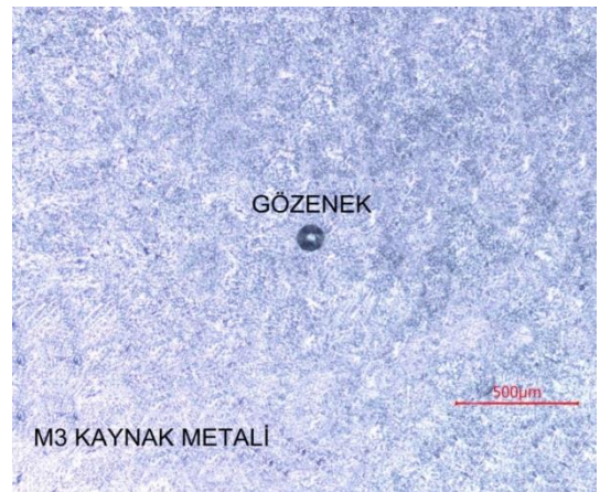
Şekil 5.45. M3 KM mikro görüntüsü 50x büyütme
