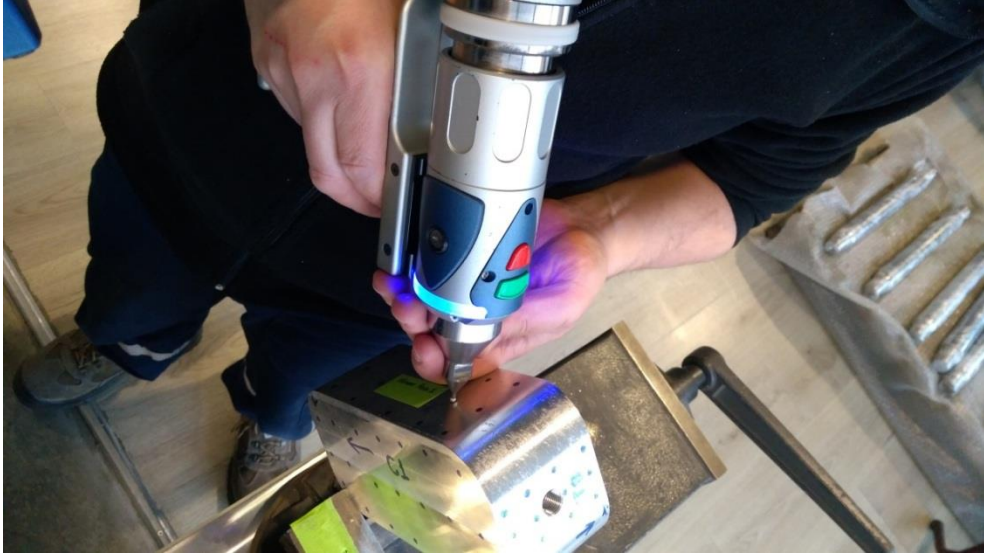
Şekil 5.70. Kaynak öncesi CMM ölçüm işleminin yapılışı
