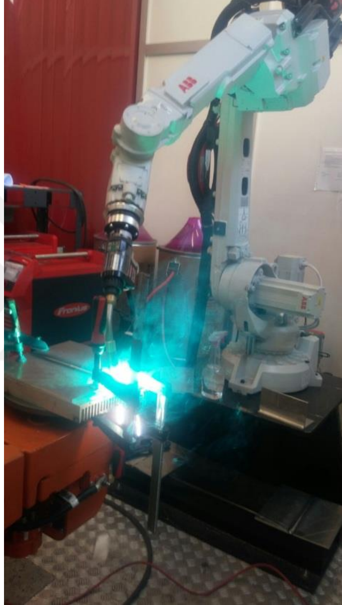
Şekil 5.5. N3 numunesi CMT-MIG robotik kaynağı ile yapılışının gösterimi
