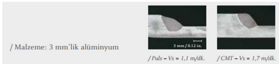
Şekil 3.13. 3 mm Alüminyum levhanın kaynağı [13]
