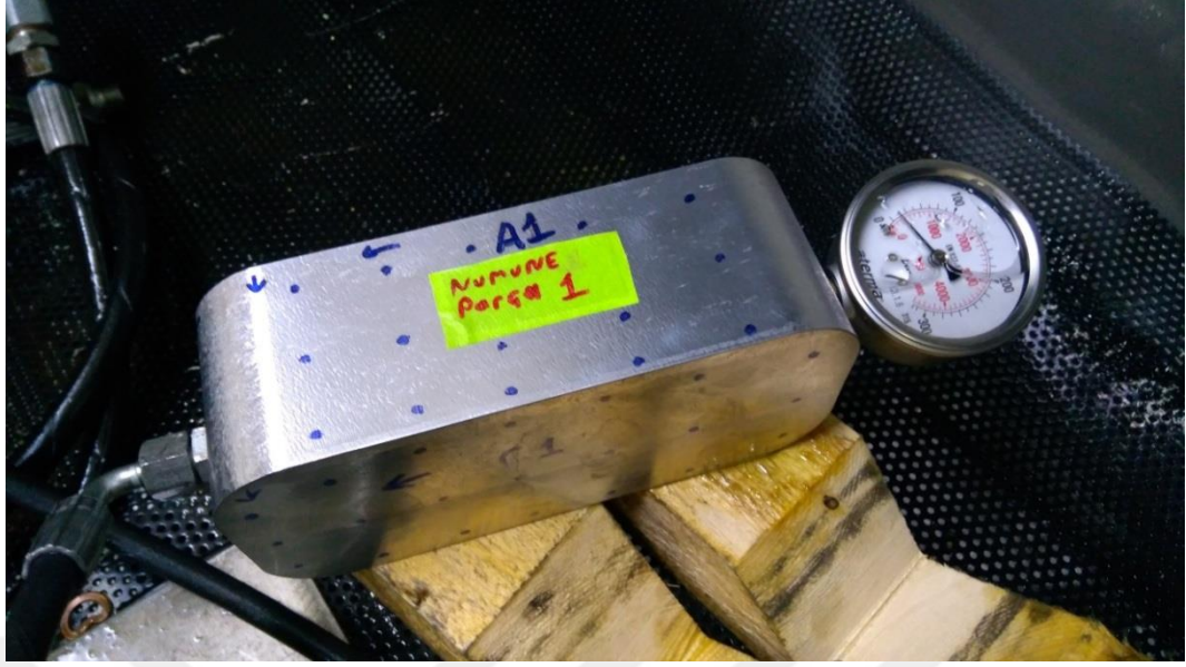
Şekil 5.67. N1 numune parçasının basınç testinin yapılışı
