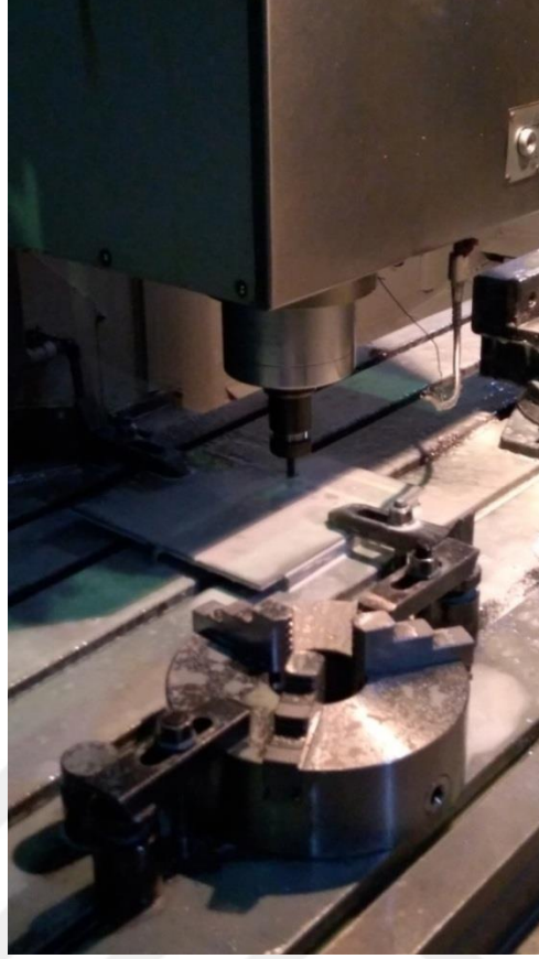
Şekil 5.9. Çekme ve eğme numunlerinin freze tezgahında işleme görseli
