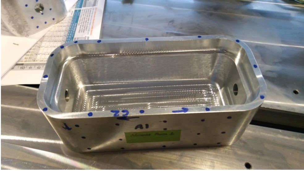
Şekil 5.69. CMM ölçümü için referans noktalarının gösterimi
