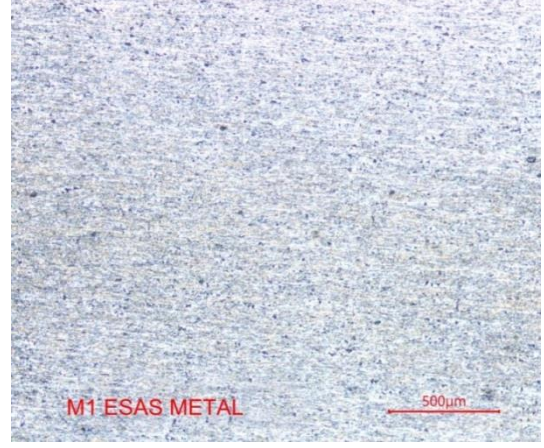
Şekil 5.23. M1 EM mikro görüntüsü 50x büyütme
