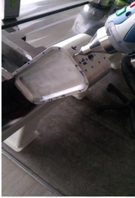
Şekil 5.87. Kaynak sonrası CMM ölçüm işleminin yapılışı
