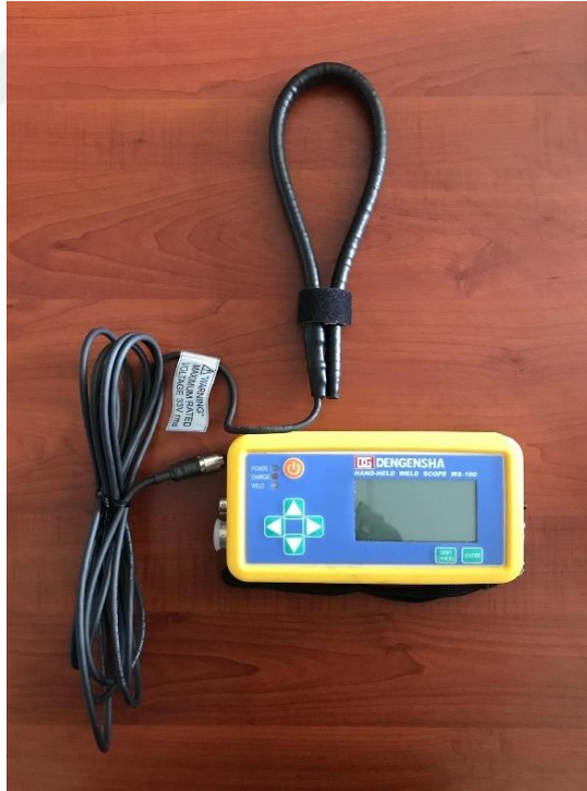
Şekil 4.4. Dengensha marka akım ölçer.
