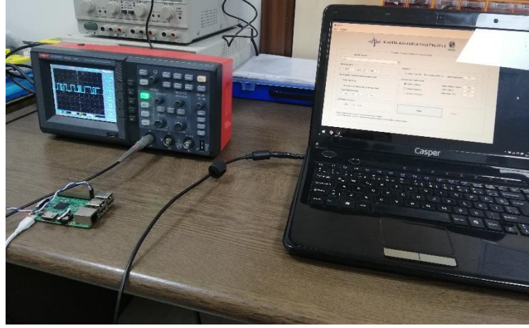
Şekil 5.15. Kablosuz ağ üzerinden üretilen sayıların Raspberry Pi'ye gönderilmesi
