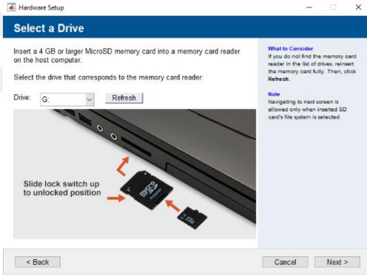
Şekil 5.9. Raspberry Pi donanım için hafıza kartına kurulum yapılandırma dosyalarının yüklenmesi
