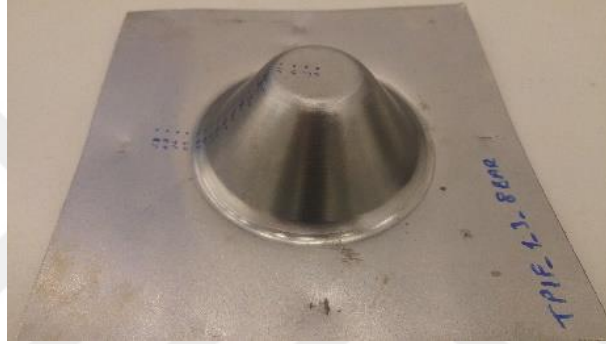
Şekil 3.8. Eksenel simetrik parçada kayar artımlı şekillendirme yönteminin kullanımı. A: Deney anı, B: Deney sonrasında elde edilen parça.
