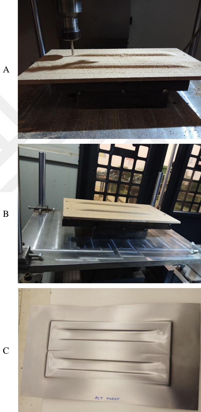
Şekil 4.97. Bir otomobil traversinin artımlı şekillendirme yöntemi ile üretim çalışmaları. A: Ahşap (sunta) modelin işlenmesi. B: Hazırlanmış model. C: Şekillendirilmiş sac
