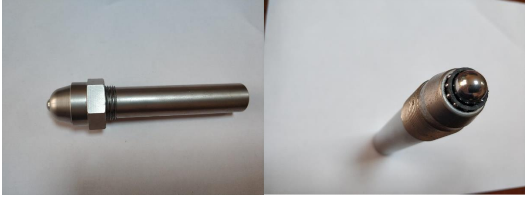
Şekil. 3.9. Yuvarlanan Uçlu Takım Montaj Modelinin İmalat Görünümü
