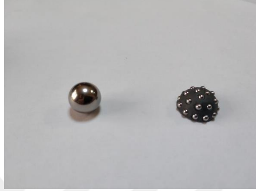
Şekil. 3.2. Şekillendirici Bilye Uç, Kafes ve Yataklama Bilyelerinin Gerçek Montaj Görünümü
