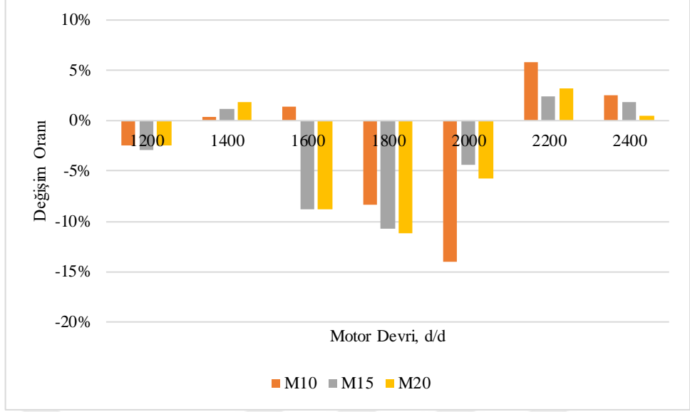
Şekil 4.13.Fumigasyon Oranı ve motor devrine bağlı olarak STD duruma göre CO 2 emisyonundaki değişimi
