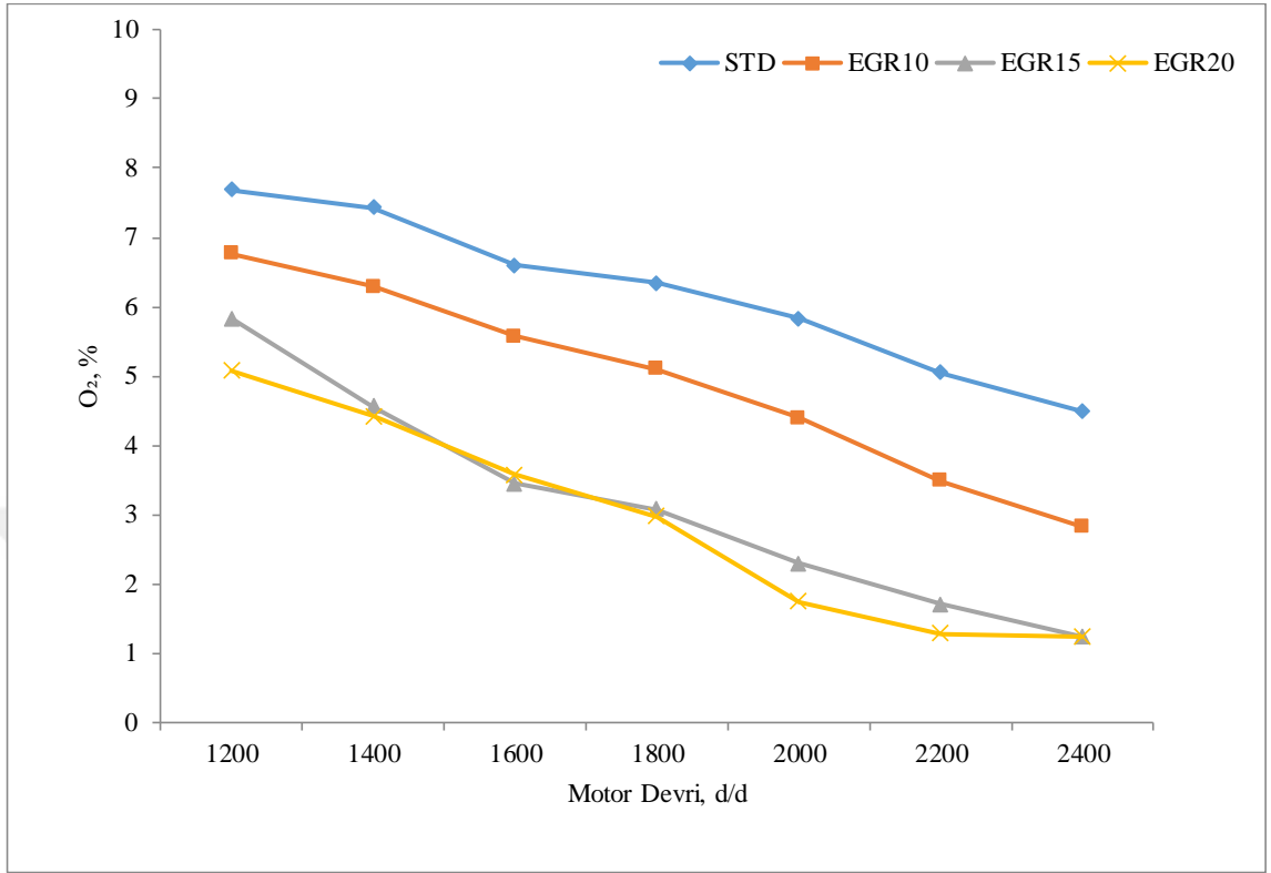
Şekil 4.36.Farklı oranlarda EGR uygulaması sonucu O 2 emisyonundaki değişim
